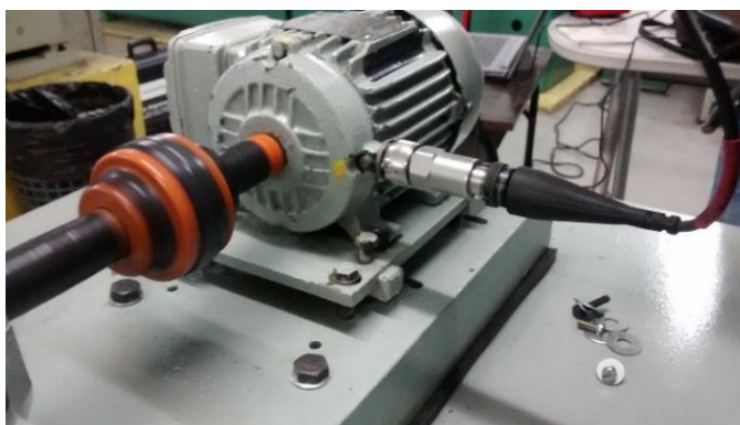
Figura 3.22: Medição de vibração no motor na posição radial horizontal
