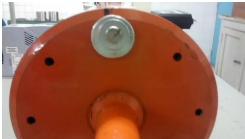
Figura 3.24: Detalhe da massa de balanceamento
