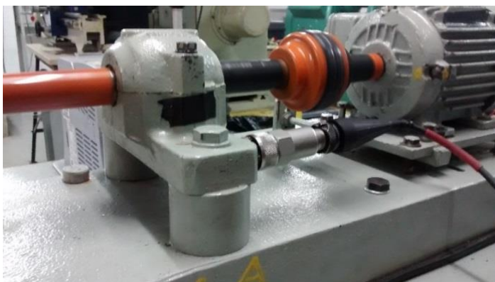
Figura 3.21: Medição de vibração no mancal na posição LA axial
