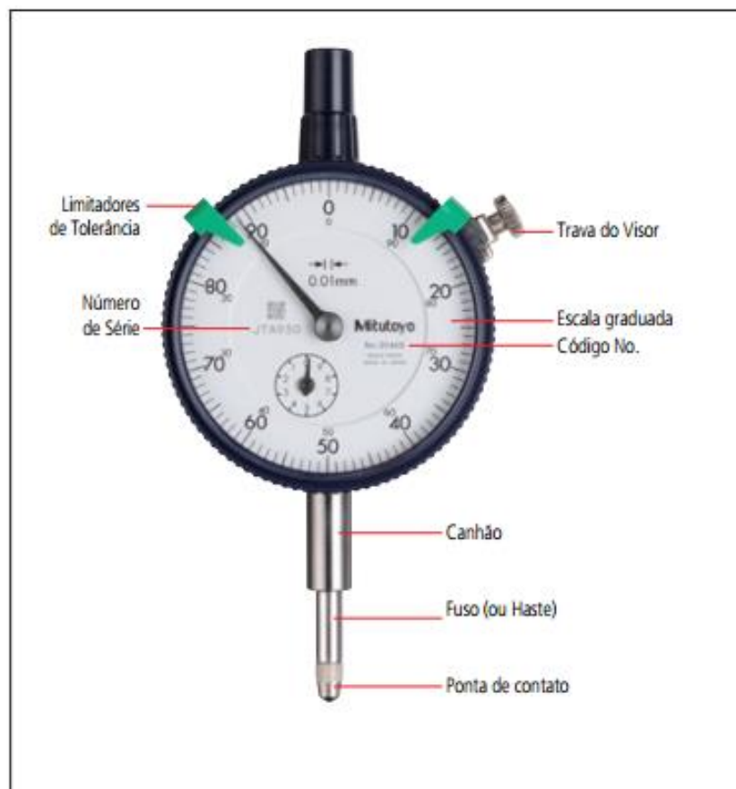
Figura 2.6: Perfil de um relógio comparador
