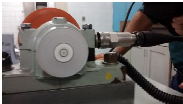
Figura 3.20: Medição de vibração no mancal na posição LOA radial horizontal
