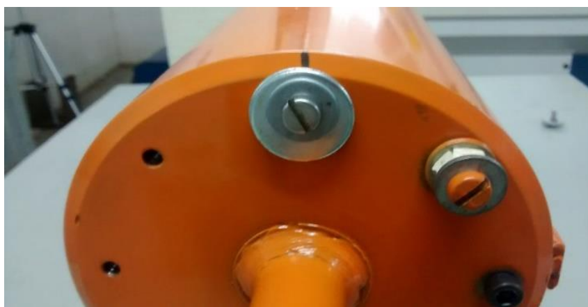
Figura 3.25: Detalhe das adições de massa
