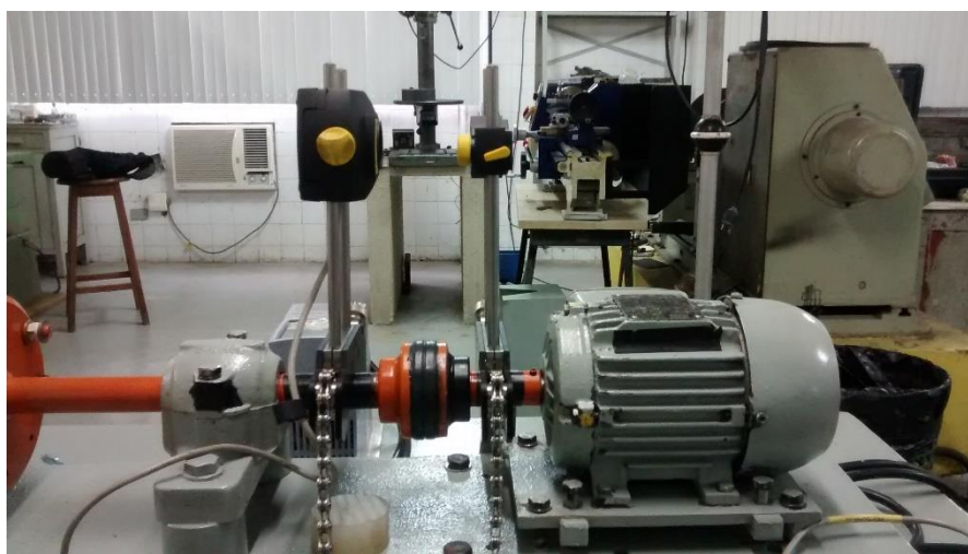
Figura 3.17: Montagem do Alinhador a laser
