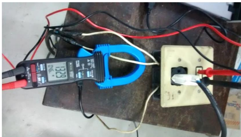
Figura 3.19: Montagem do alicate wattímetro
