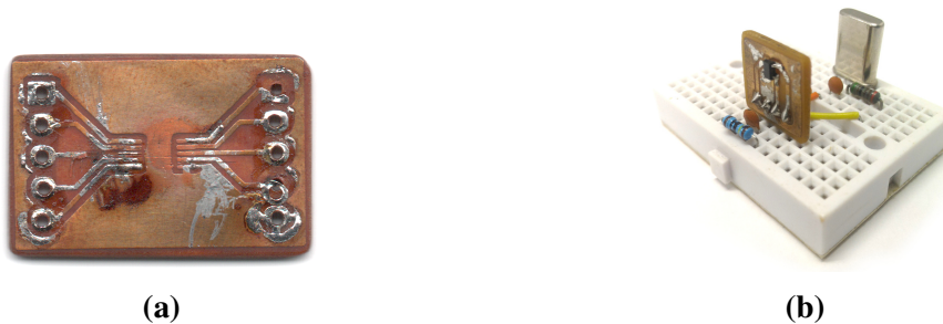
Figura 4.16: Placa individual de um dos chips conversores de tensão (a) e circuito de relógio externo, montado na protoboard (b)
