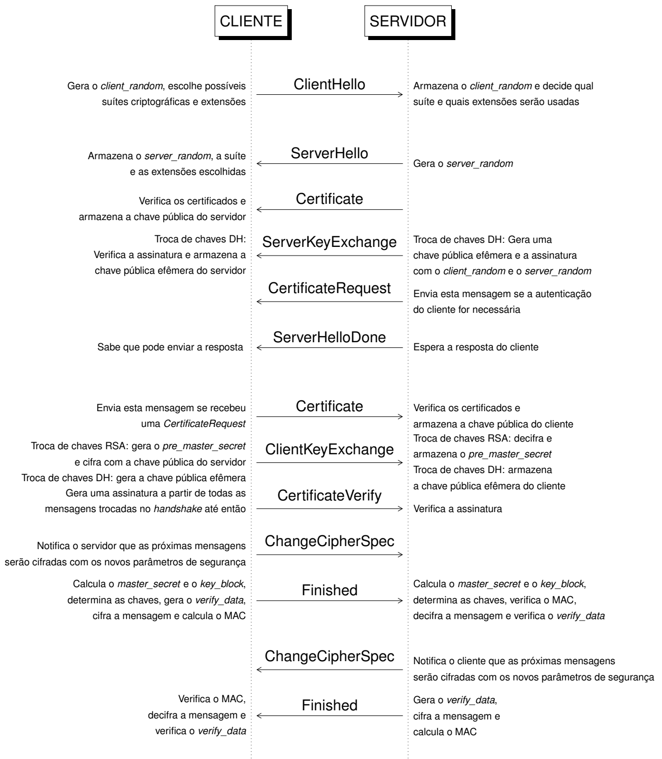
Figura 2.15: Diagrama da troca de mensagens entre Servidor e Cliente, durante o Protocolo de Handshake do TLS
