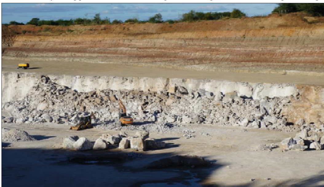
Figura 29: Mineração de gipsita através do método Open Pit Mining com bancadas múltiplas, Araripina/PE
