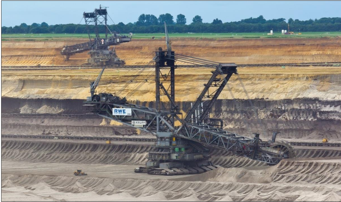
Figura 24: Bucket Wheel Excavators 288 e 258 na Mina de Carvão Tagebau Garzweiler
