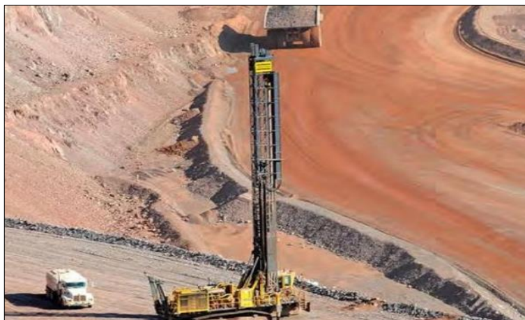
Figura 4: Operação de perfuração com carreta de perfuração rotativa
