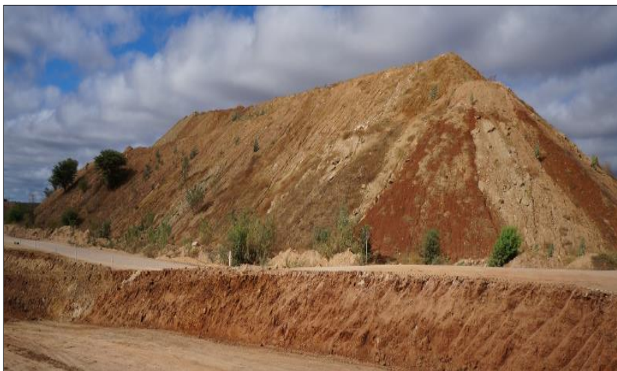
Figura 44: Pilha de estéril a 1,4 km da frente de lavra na operacionalização do método Open Pit Mining
