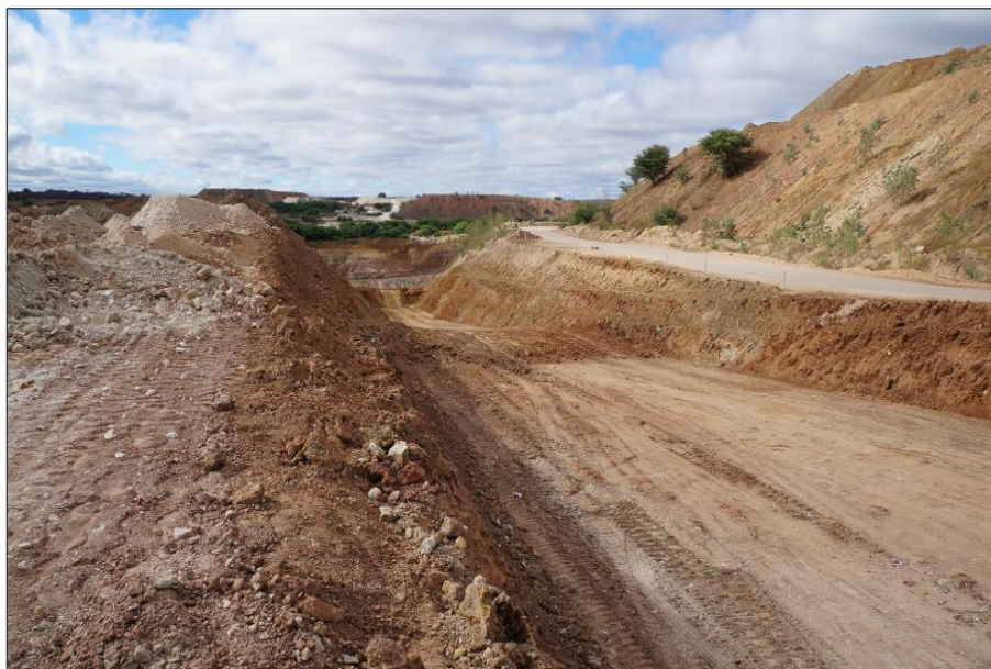
Figura 45: Rampa desenvolvida para aplicação do método Terrace Mining
