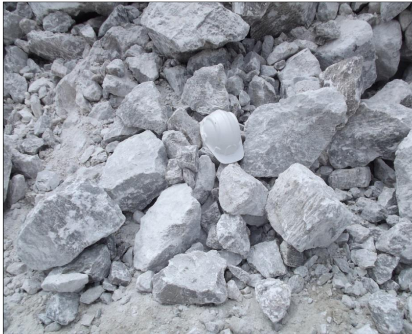
Figura 36: Resultado do desmonte com explosivos
