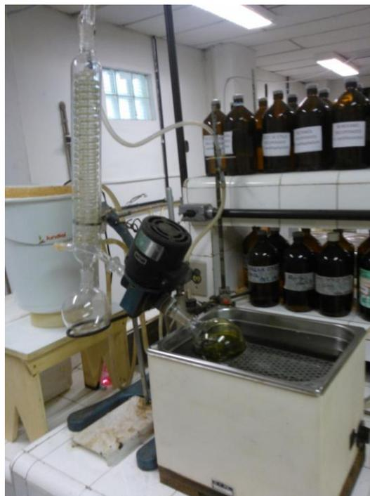
**Figura 4** - Concentração do extrato com rotaevaporador.
