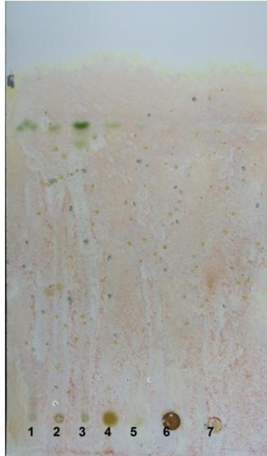
**Figura 13** - Avaliação da presença de alcalóides. [1] diclorometano, [2] ciclohexano, [3] clorofórmio, [4] acetona, [5] acetato de etila, [6] metanol e [7] pilocarpina (padrão).
