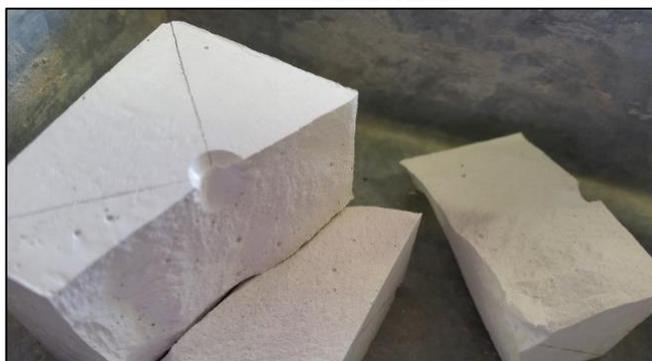
É evidente que o aumento da relação água/gesso diminui a rigidez e aumenta a capacidade de deformação do material, uma vez que foi possível obter os valores de dureza para os gessos com relação água/gesso de 0,8, como apresenta a Figura 4.19. Os valores individuais de dureza estão no Apêndice H.
