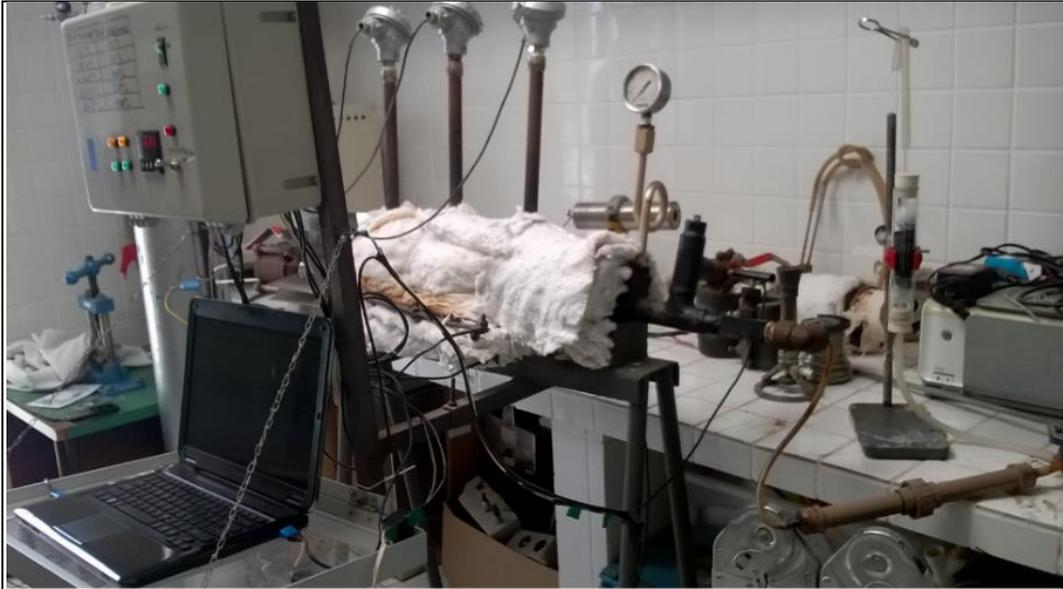
Figura 22 - Mini gaseificador acoplado a coluna de adsorção
