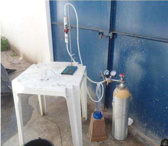
Figura 18 – Montagem da etapa da adsorção
