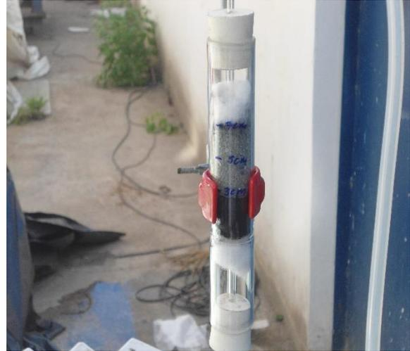
Figura 19 – Montagem experimental da coluna de adsorção
