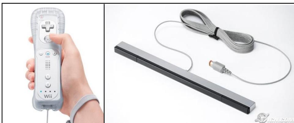
**Figura 2.3: Wii Remote (esquerda) e barra de captura (direita).**
