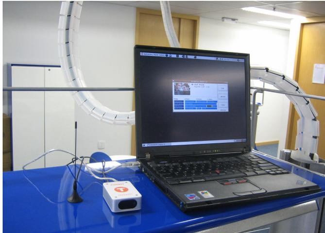
**Figura 5.3. Notebook conectado com antena DVB-T USB**
