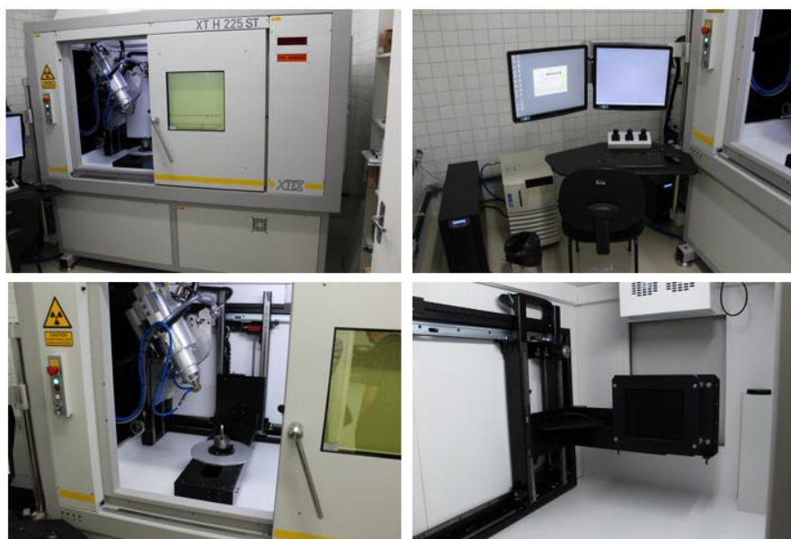
Figura 3. Microtomógrafo NIKON XT-H 225 ST acoplado a um computador de comando.
