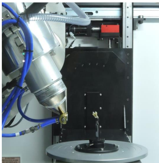
Figura 2. Posicionamento da amostra no microtomógrafo
