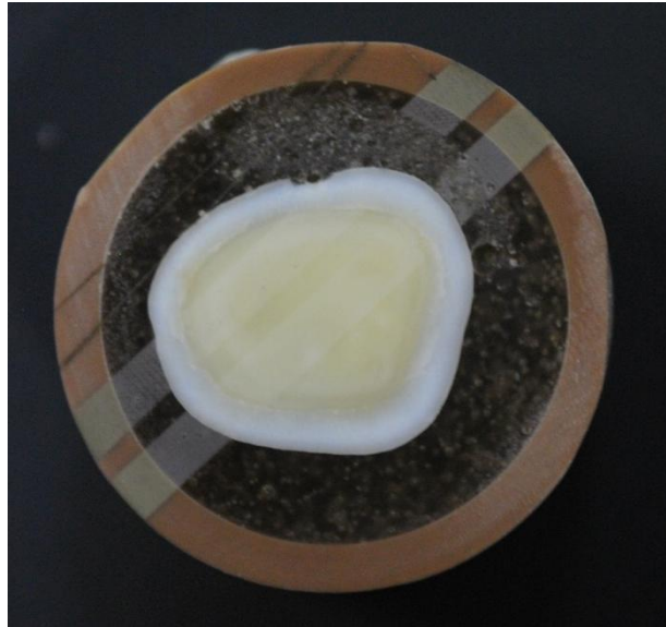
Figura 8 – Superfície da amostra irradiada pelo LASER de Ti:Safira.
