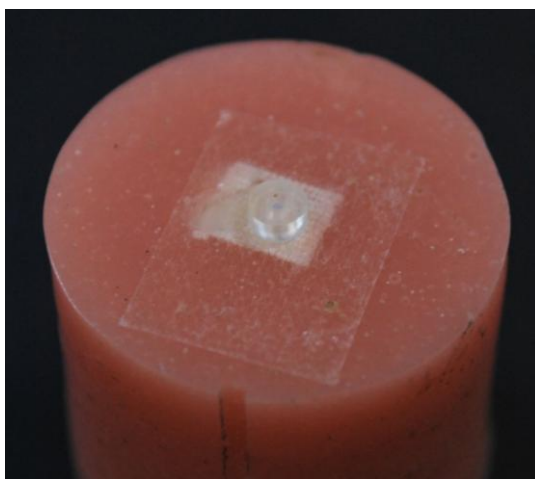
Figura 3 - Matriz transparente de polietileno inserido sobre fita dupla face perfurada.
