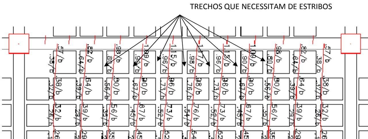
**Figura 5.20 - Trechos de momentos negativos que necessitam de armadura de cisalhamento - simulação 3**
