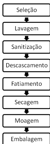
Figura 3.0 Fluxograma do processamento de farinha de batata-doce cultivar Beauregard
