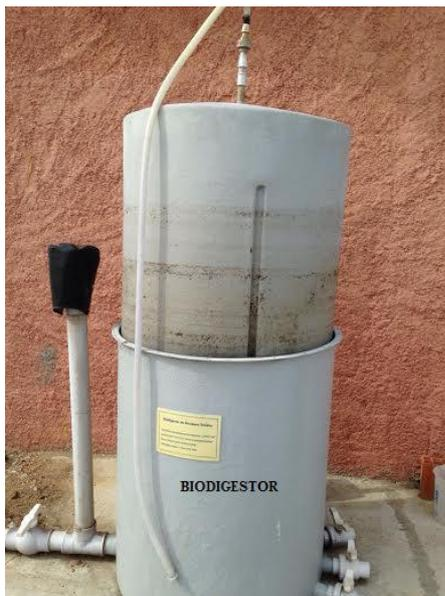
Figura 21 (4): Deslocamento vertical da parte superior do biodigestor decorrente da pressão interna do biogás
