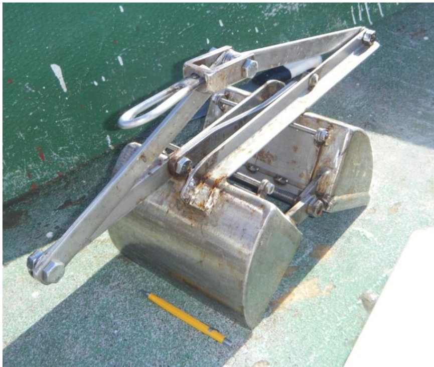
Figura 6 - Draga de fundo do tipo Van Veen utilizada na coleta das amostras de sedimentos
