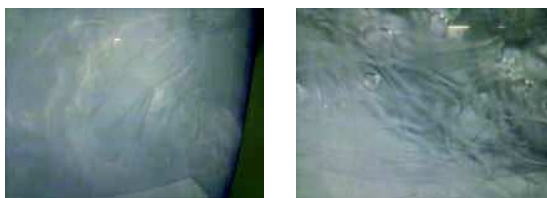
Figura 4.15: Foto obtida utilizando o auxílio de um microscópio óptico das amostras que apresentaram capilares. A imagem da esquerda corresponde amostra contendo 1% de alginato de sódio em contato com CaCl_2 a 0,5M durante 11 dias. A imagem da direita apresenta a amostra contendo 2% de alginato de sódio em contato com CaCl_2 a 1M. O campo de visão de cada amostra é aproximadamente 2,5 mm x 2,5 mm.
