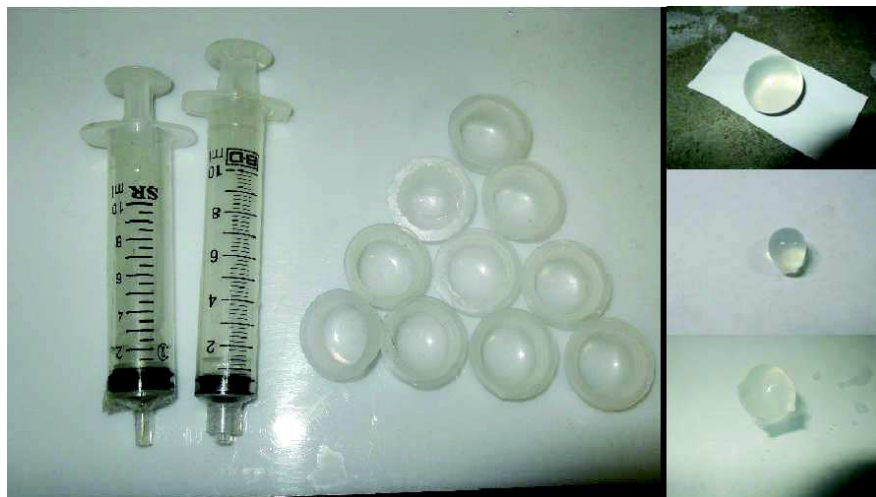
Figura 3.4: Lado esquerdo da figura mostra as seringas e os pequenos recipientes (tampas) utilizados para fabricação das esferas de alginato de cálcio. Lado direito da figura exemplificam a forma final de algumas das esferas feitas com essas tampas de frascos químicos, que possuíam, aproximadamente, 1,5 cm de diâmetro.
