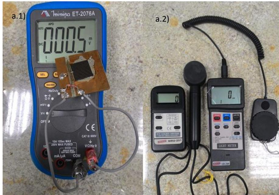
**Figura 17**-a.1) Célula padrão de silício conectada ao multímetro, onde o valor de 407 mV equivale a potência de  $0,1\text{W}/\text{cm}^2$  da radiação solar incidente (1 Sol) a.2) Equipamentos que permitem a determinação da radiação incidente correspondente a radiação UV-Vis.
