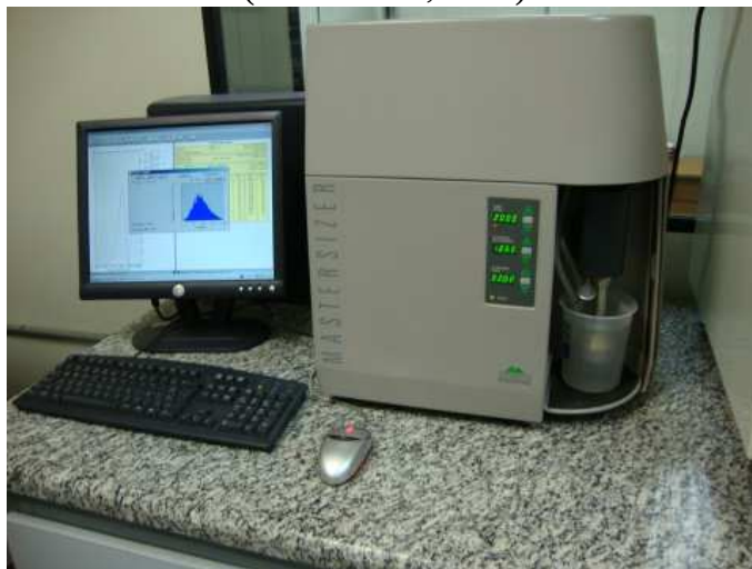
Figura 3.3 Aparelho analisador de partículas por difração a laser “granulômetro” (FERREIRA, 2013)
