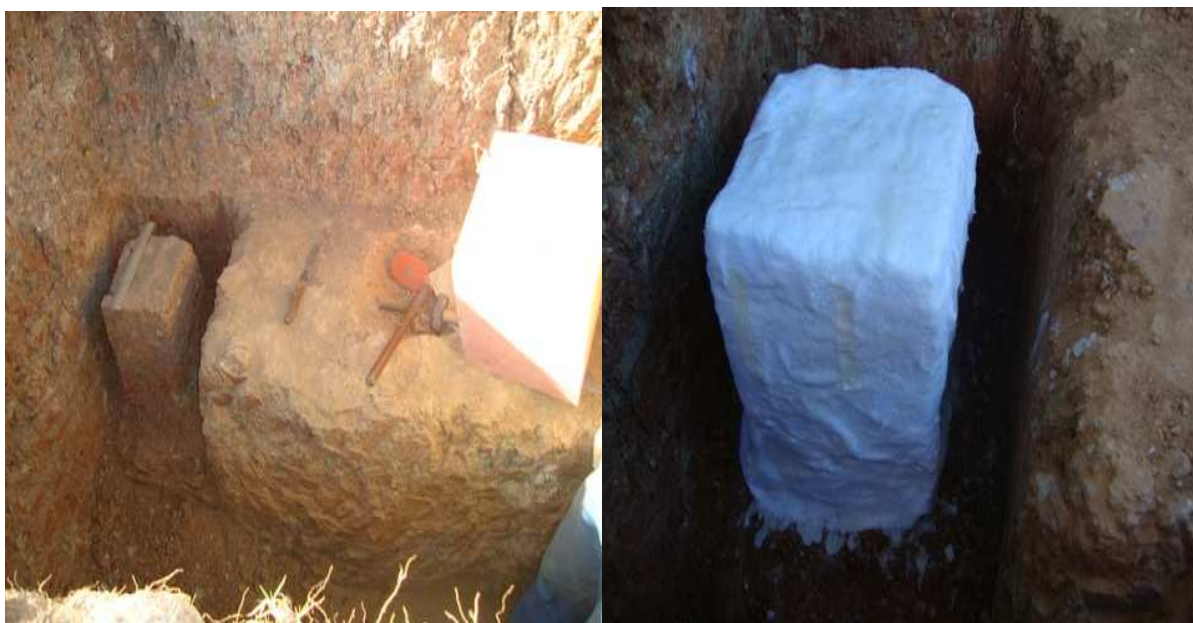
Figura 3.2 Coleta de amostras indeformadas no município de Paulista
