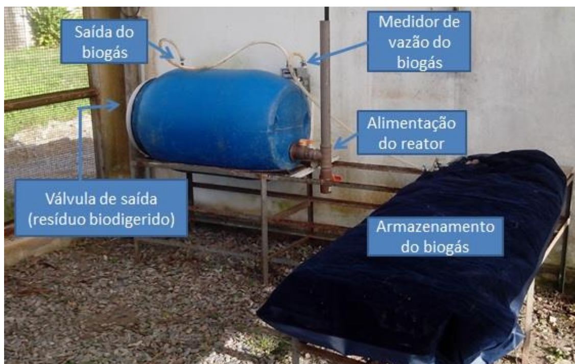
Figura 14 - Reator de 200 L utilizado no experimento de biodigestão de resíduos alimentares.
