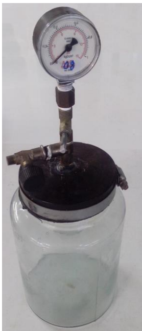
Figura 13 - Reator de bancada para experimentos de biodigestão anaeróbia.
