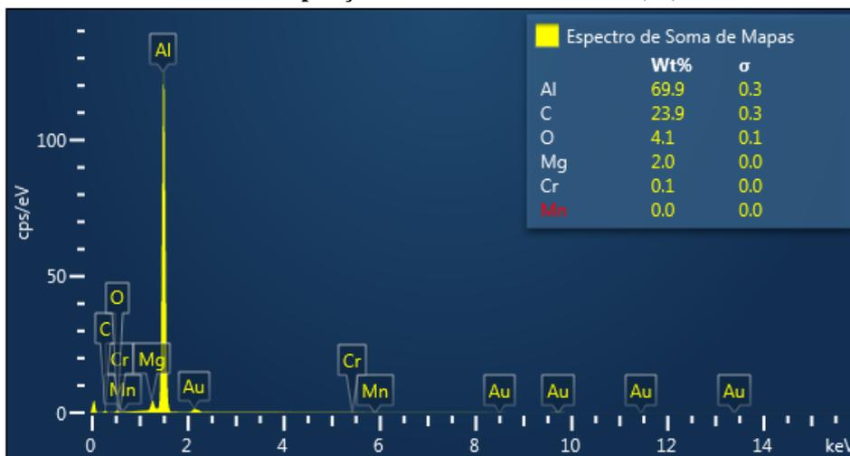
A Figura 5.5 refere-se a técnica de EDS por mapeamento de raio-x, demonstrando que a concentração de carbono é centralizada sobre o micro-organismo. Esta técnica permite uma redução da interferência dos elementos componentes da matriz metálica na quantificação dos elementos presentes no biofilme.
