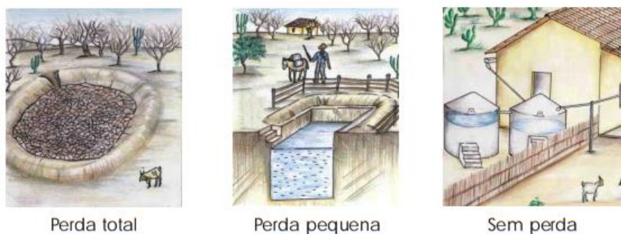
Figura 21-Perda de água das fontes por evapotranspiração
