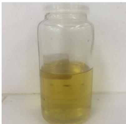
Figura 5.2 – Biodiesel do óleo de Algodão refinado: T (40°C); A:O (6:1); W<sub>cat</sub> (0,7%); V<sub>agit</sub> (640 rpm), tempo (1 h); secagem (chapa aquecedora 60 min); teor água (164,6 mg.kg<sup>-1</sup>); teor de éster (98,1%).
