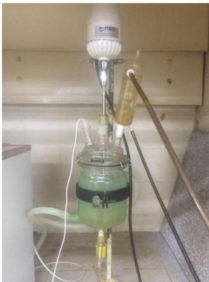
Figura 4.1 – Aparato experimental utilizado na transesterificação.
