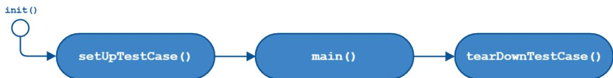
**Figura 3.3:** Diagrama de estados da execução de um teste no *framework* FREVO.
