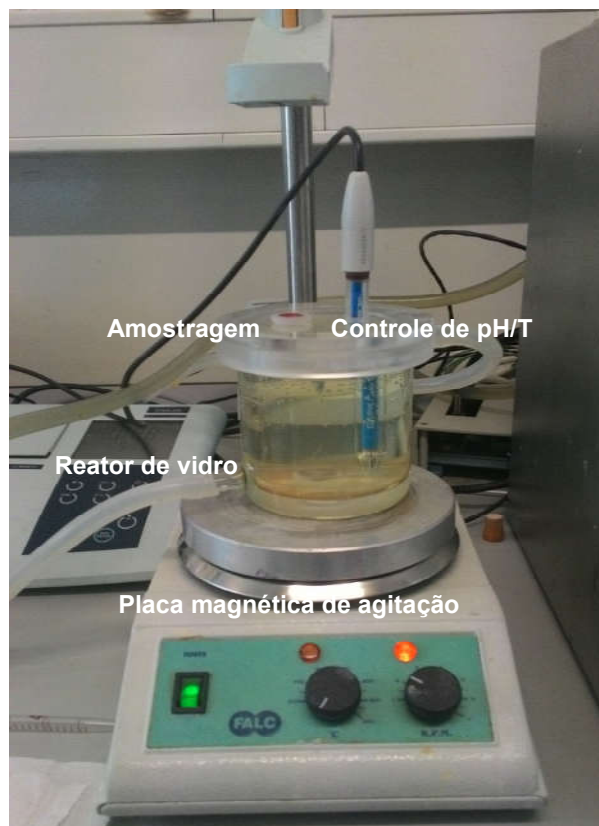
Figura 5 - Reator de vidro utilizado na reação de Fenton.
