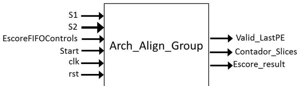
**Figura 90 Arquitetura interna do módulo Arch\_Align\_Group**
