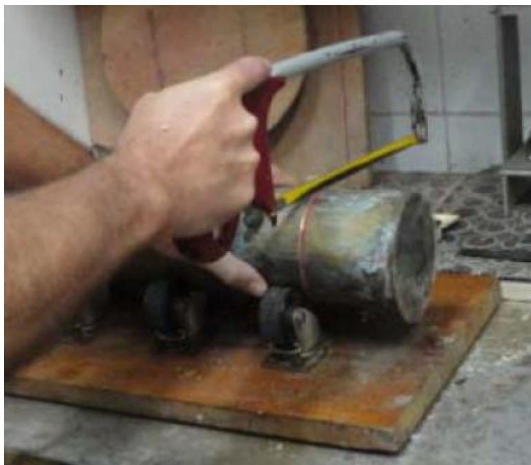
Figura 9. Cortando um trecho do bico do amostrador/amostra.
