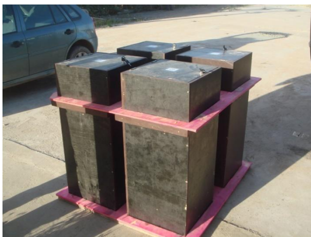
Agrupamento das caixas para reduzir o efeito de vibrações
