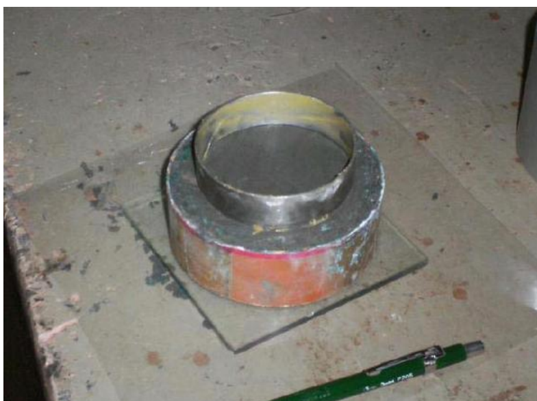
Figura 12. Anel metálico posicionado sobre a amostra para ser cravado.
