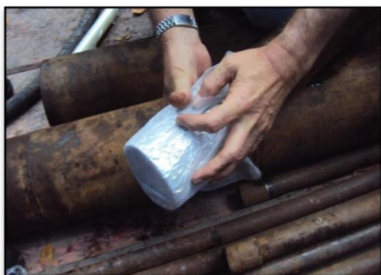
Colocação da tela de proteção
