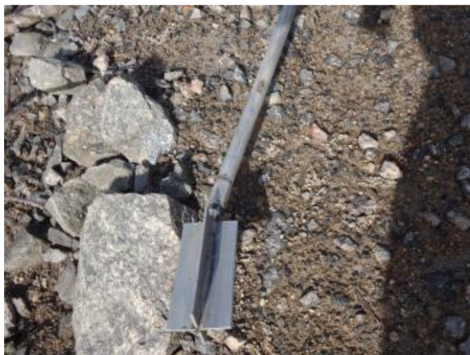
Figura 1. Danificação da palheta ao realizar ensaio em solo resistente.
