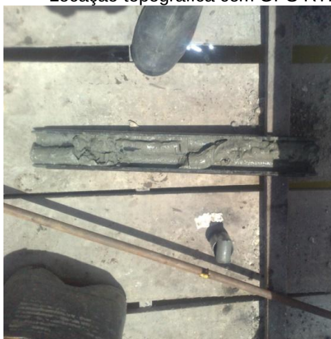
Coleta de amostra do amostrador-padrão
