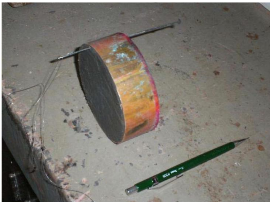
Figura 11. Introdução do fio de aço junto a interface solo-tubo amostrador.
