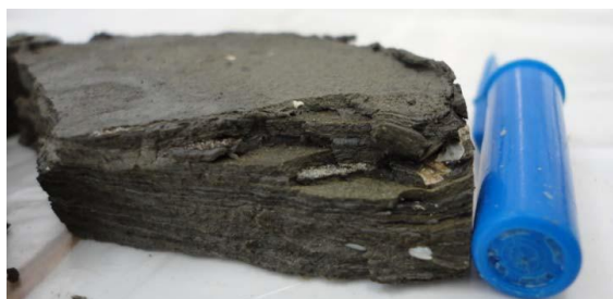
Amostra AM-2-5 , apresentando uma visível estratificação horizontal.
