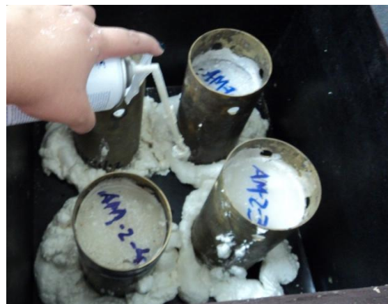
Colocação da espuma de poliuretano para fixação das amostras
