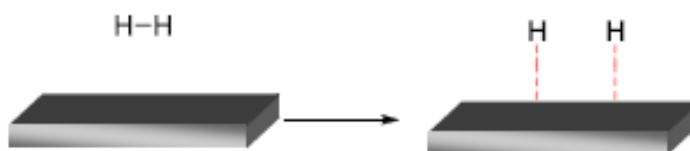
Figura 1. Adsorção de H_2 paralela à superfície metálica (figura adaptada da Ref. 18).
