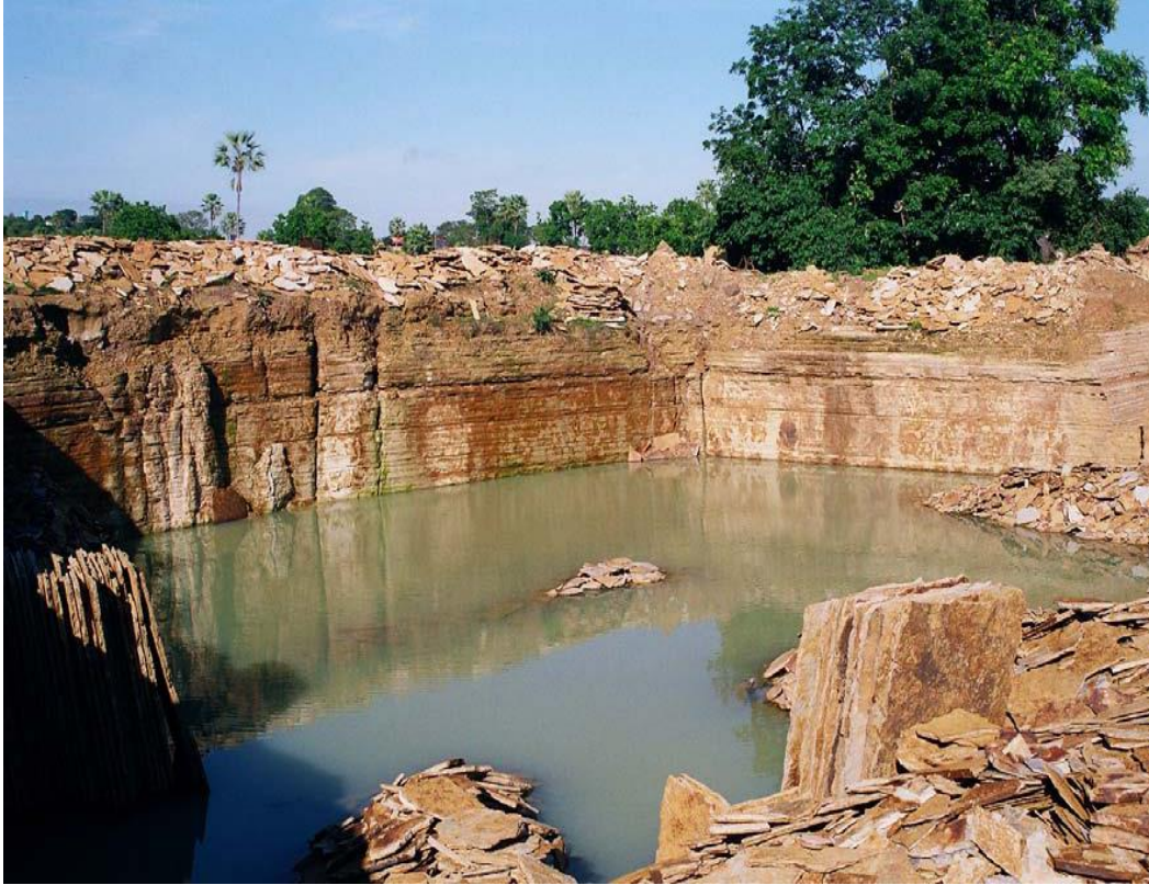
Figura 15. Área de extração artesanal de quartzito, abandonada, proporcionando acúmulo de água e causando dano ambiental. Mina localizada no município de Castelo do Piauí, PI.
