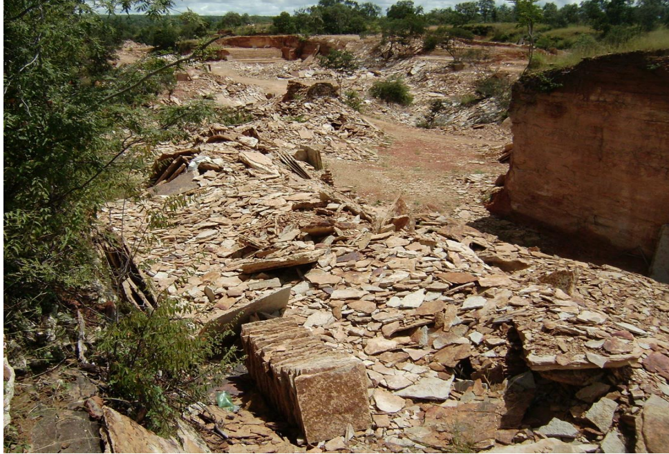
Figura 4. Área de extração artesanal de quartzito, onde o rejeito é deixado dentro da mina, proporcionando germinação e crescimento de plantas nativas, causando dano ambiental de menor extensão em relação a extração mecanizada. Mina localizada no município de Castelo do Piauí, PI.
