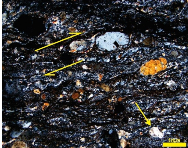
Fotomicrografia 4.7: Pórfiros menores confundidos com a matriz no círculo e sigmoides de k feldspato
