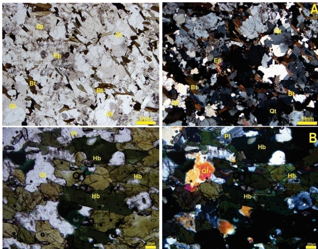
Fotomicrografia 3.6: A- Nicóis paralelos (esquerda) e nicóis cruzados (direita): Bandamento félsico, granulação fina a média e B- Nicóis paralelos (esquerda) e nicóis cruzados (direita): Bandamento máfico, granulação média a grossa.
