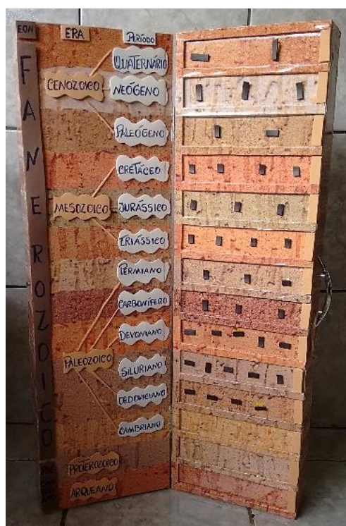
Figura 6 - Elaboração das divisões do tempo geológico no modelo didático e disposição dos ímãs nas estruturas móveis dos compartimentos.
