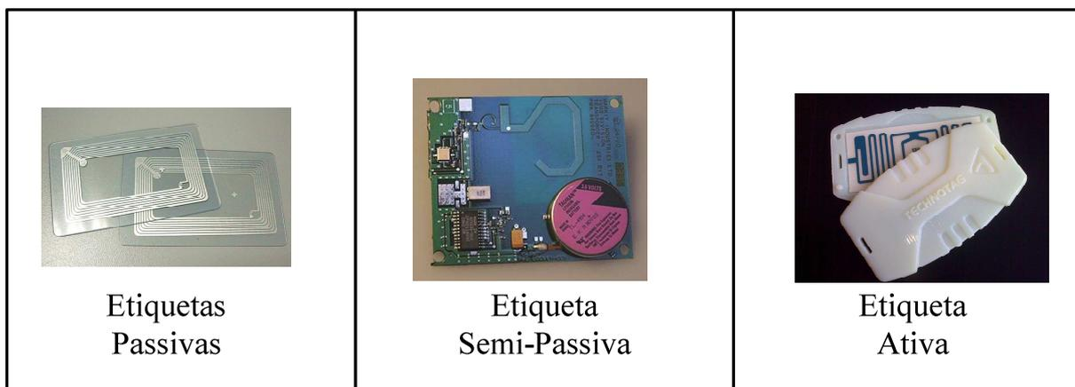
**Figura 7 - Exemplos de Etiquetas RFID.**
