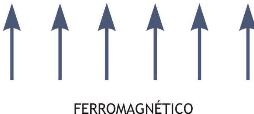
Figura 2. 5: Esquema que representa os momentos magnéticos de um material ferromagnético. Na ausência de campo magnético externo esses momentos permanecem alinhados.
