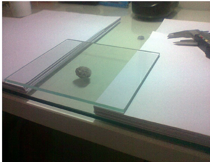
Figura 4.2 Foto representando o experimento. A amostra está entre duas placas de vidro, na qual a distância entre elas é medida pelo número de folhas de papel A4 empilhadas nos dois lados.
