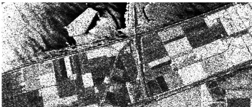
Figura 3.2 Padrão do ruído speckle em uma imagem SAR.
