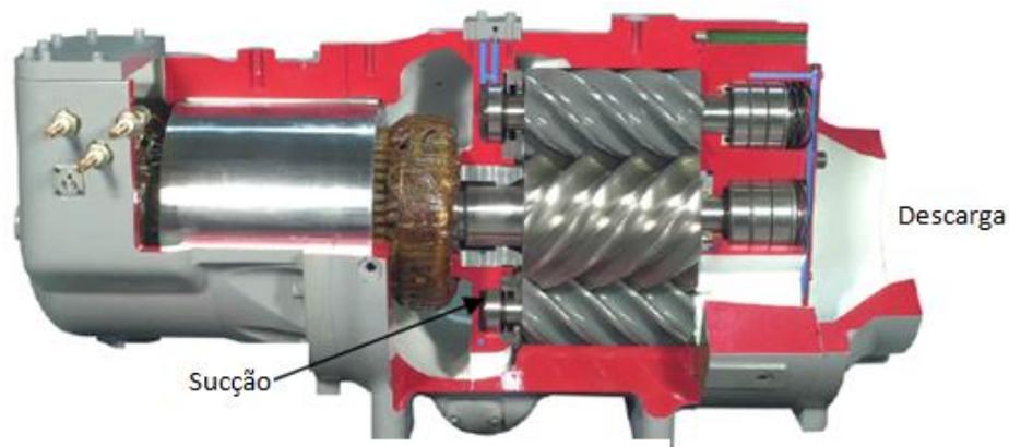
O processo de compressão para o tri-rotor é realizado com um conjunto de rotores mostrados na Figura A1.4. Este conjunto particular tem uma combinação de 8 lóbulos masculinos e seis em ambos femininos (Jacobs, 2006).
