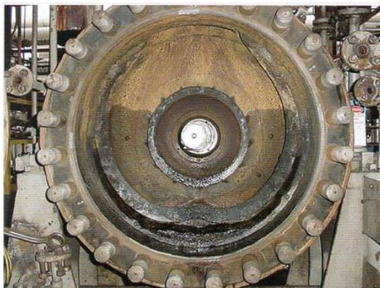
Após a passagem pela voluta o gás alcança o primeiro impelidor, na Figura A1.6 é possível observar que o gás passa pelas formas internas e seu retorno para as zonas de menor pressão, é guiado pelos canais de passagem.
