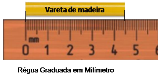
Figura 19. Medição por meio de régua graduada em milímetros. Fonte: banco de dados do pesquisador
