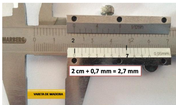
Figura 25. Medição de uma peça com um paquímetro de 20 divisões. Fonte: Banco de dados do autor.
