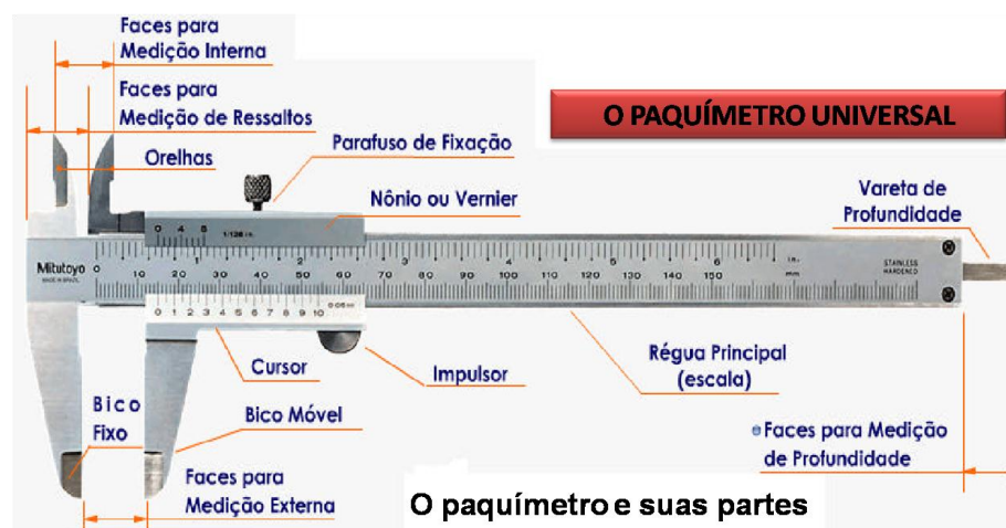
Figura 20 - paquímetro analógico. Fonte: http://paquimetro.reguaonline.com adaptado pelo pesquisador
