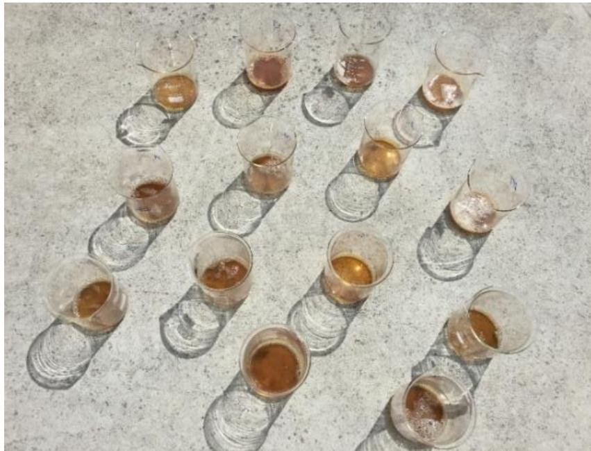
**Figura 3.6:** Amostras em ambiente externo sob a radiação solar para o tratamento por foto-Fenton.
