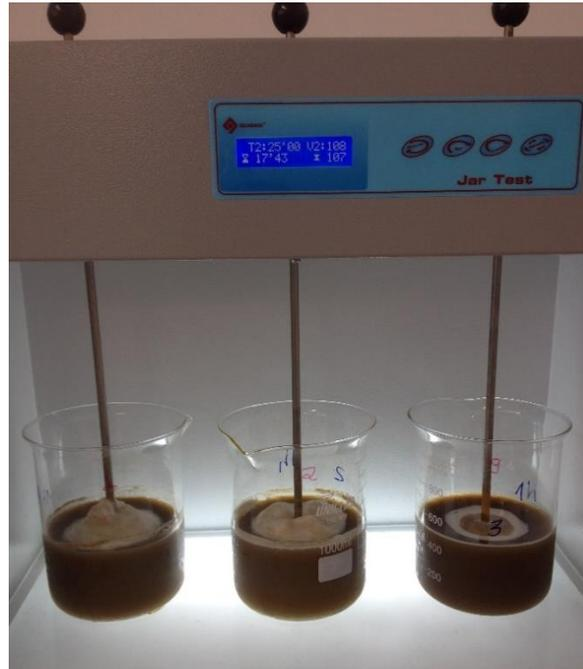
**Figura 3.4:** Equipamento de *Jar Test* utilizado nos ensaios de CF.
