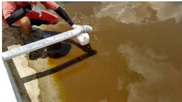
**Figura 3.3:** Coleta do lixiviado bruto na entrada do reservatório do evaporador de Altinho
