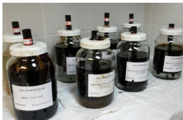
Figura 3.8. Sistemas dinâmicos para monitoramento do processo de corrosão em diferentes fluidos
