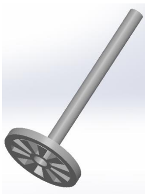
Figura 3.6. Desenho das hastes utilizadas na fixação e agitação dos corpos de prova nos sistemas dinâmicos
