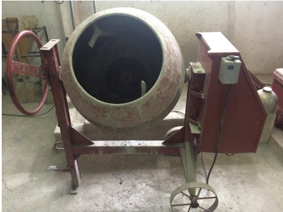
Figura 40: Betoneira. Laboratório de Tecnologia do Concreto - UFPE Fonte: Autor, 2015.
