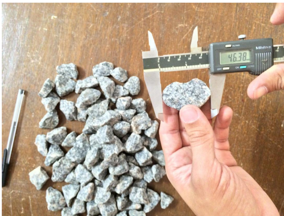
Figura 48: Medição das Britas com paquímetro Fonte: Autor, 2015.
