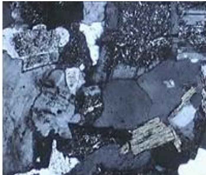
Figura 12: Textura holocristalina de um granito, observado ao microscópio óptico, (luz transmitida, nicóis cruzados);
