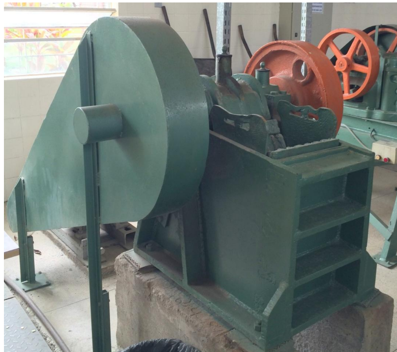
Figura 34: Britador de mandíbulas, de 1 (um) eixo. Laboratório de Tecnologia Mineral - UFPE Fonte: Autor, 2015.
