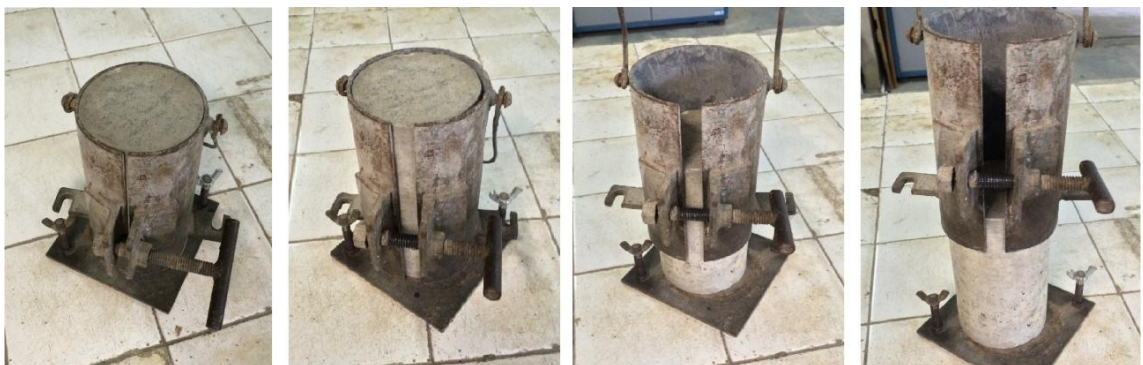
Figura 44: Folga de parafusos e retirada do molde. Laboratório de Tecnologia do Concreto - UFPE Fonte: Autor, 2015.
