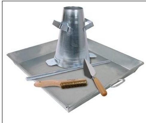
Figura 43: Tronco de cone e conjunto para determinação do abatimento. Fonte: www.portuguese.com
