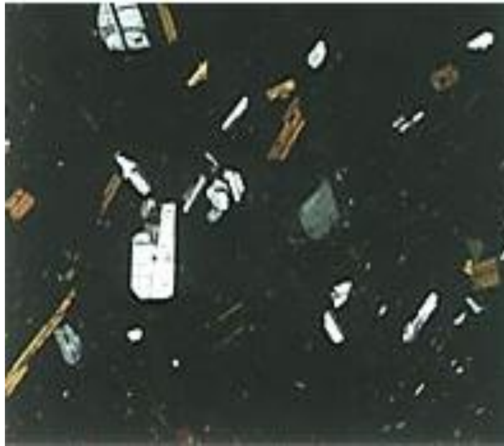
Figura 13: Textura hipocristalina de uma rocha vulcânica, observada ao microscópio óptico, (luz transmitida, nicóis cruzados), (o vidro aparece negro na imagem). Fonte: Mackenzie 1982
