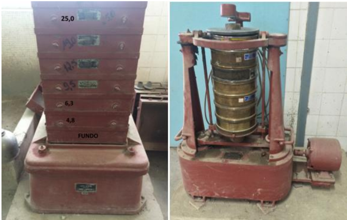
Figura 37: Peneiradores mecânicos. Laboratório de Tecnologia do Concreto - UFPE. Fonte: Autor, 2015.
