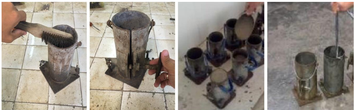
Figura 42: Limpeza, montagem e moldagem. Laboratório de Tecnologia do Concreto - UFPE Fonte: Autor, 2015.
