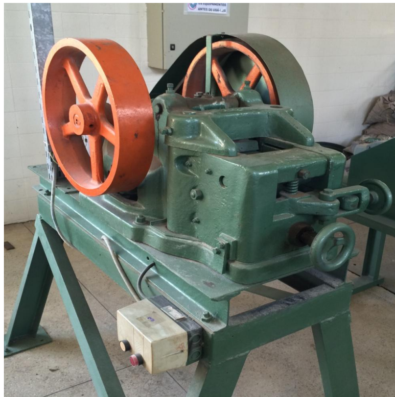
Figura 35: Britador de Mandíbulas de 2 (dois) eixos. Laboratório de Tecnologia Mineral - UFPE Fonte: Autor, 2015.
