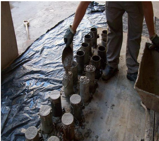
Figura 7: Colocação do concreto nos moldes
