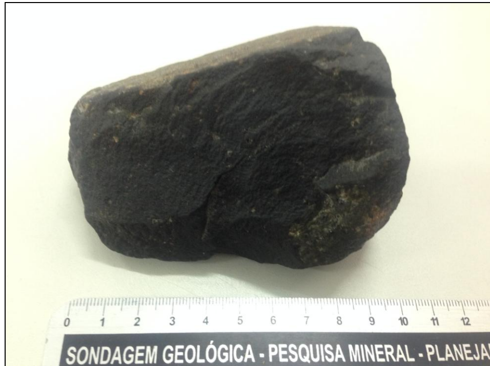
Figura 16: Textura afanítica de um basalto, Observado em amostra de mão. Fonte: Autor, 2016.
