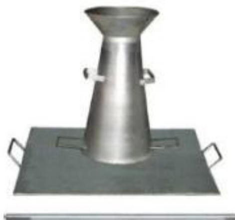
Figura 3: Conjunto para determinação de abatimento do tronco de cone: base plana, funil, cone tronco-cônico e haste socadora.
