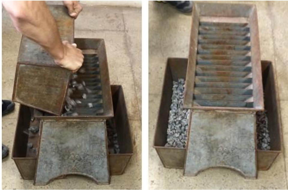
Figura 38: Quarteador Jones. Laboratório de Tecnologia Mineral - UFPE Fonte: Autor, 2015
