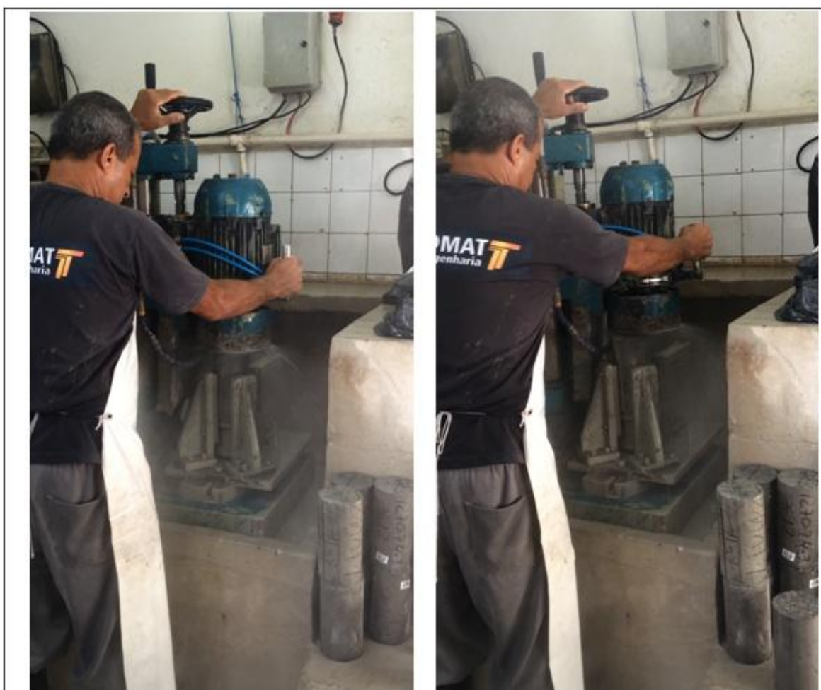
Figura 46: Retificação dos corpos de prova - TECOMAT Fonte: Autor, 2015.
