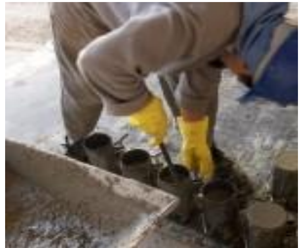
Figura 8: Emprego da haste de socamento nos corpos-de-prova
