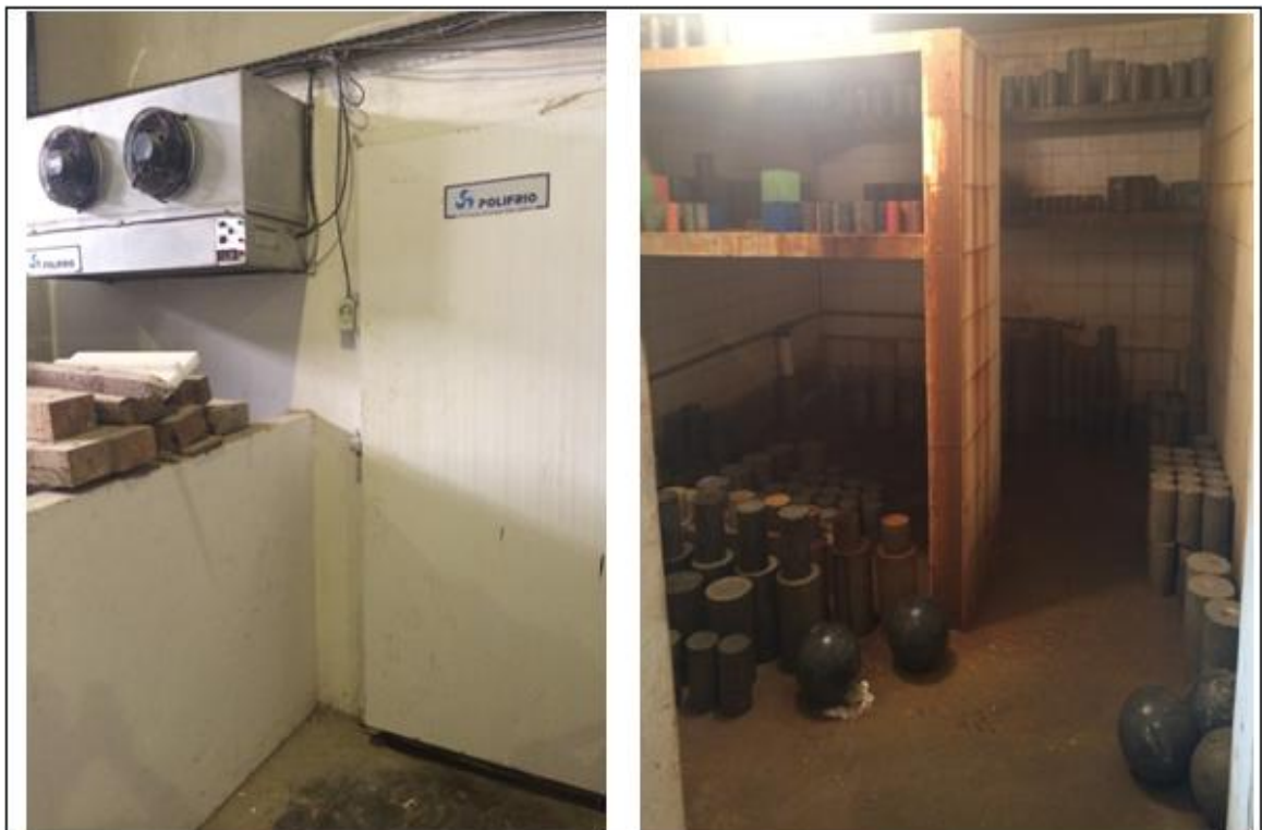
Figura 45: Câmara úmida, exterior e interior. Laboratório de Tecnologia do Concreto - UFPE Fonte: Autor, 2015.
