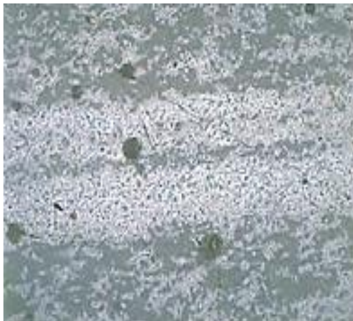
Figura 14: Textura holohialina de um vidro vulcânico, observado ao microscópio óptico, (luz transmitida, nicóis paralelos). Fonte: Mackenzie 1982
