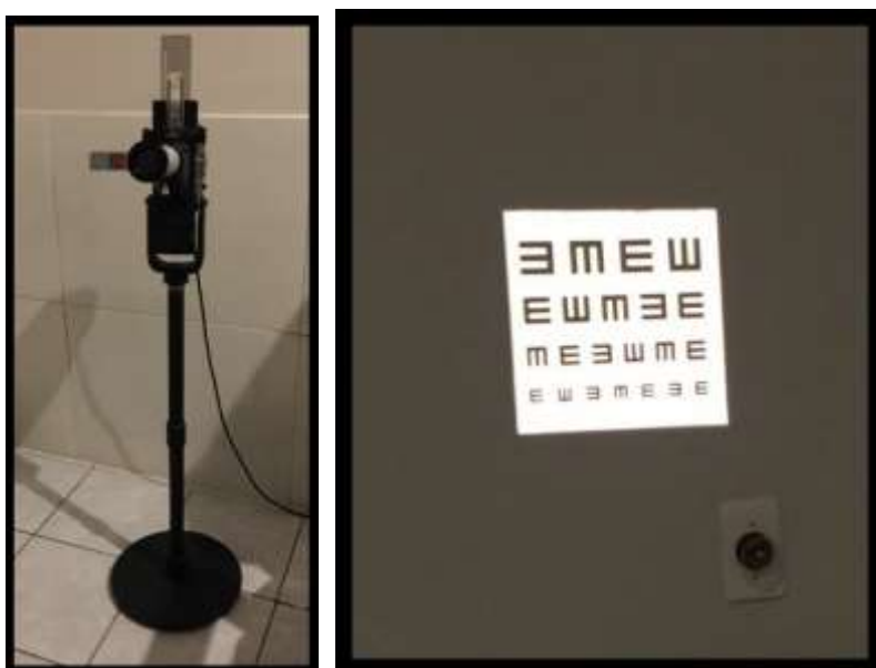
Figura 143: Projetor oftalmológico para teste de acuidade visual e projeção da Escala de Snellen. Fonte: Do autor.
