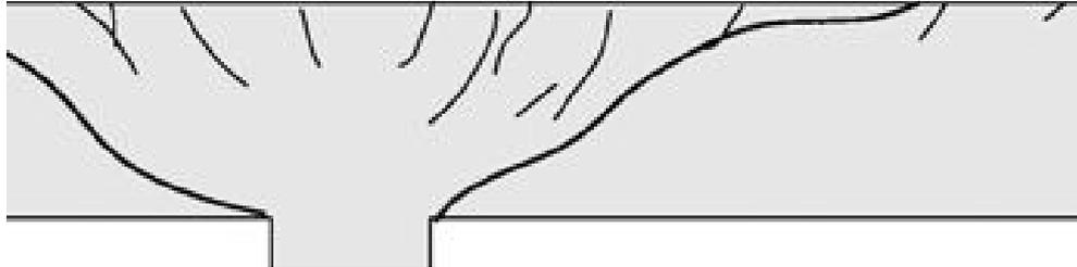
**Figura 2. 15 - Zona de ruptura em lajes submetidas ao punção, sem armadura de punção.**
