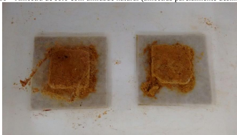
Foto 4.16 – Amostra de solo com umidade natural (amostras parcialmente desintegradas)
