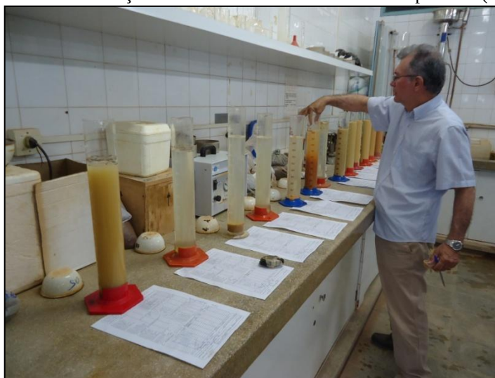
Foto 4.12 – Realização de ensaios Sedimentométrico Comparativo (SCS)
