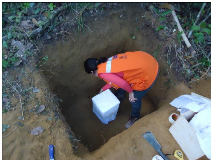
Foto 4.11 - Coleta de amostra indeformada
