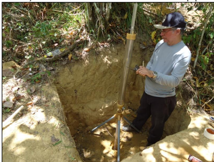
Foto 4.15 – Realização de ensaio de condutividade hidráulica com equipamento Guelph.
