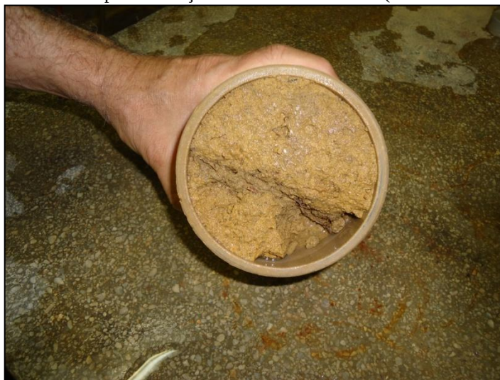
Foto 4.14 – Amostra de solo após realização de ensaio Inderbitzen (amostra seca ao ar por 72 horas)
