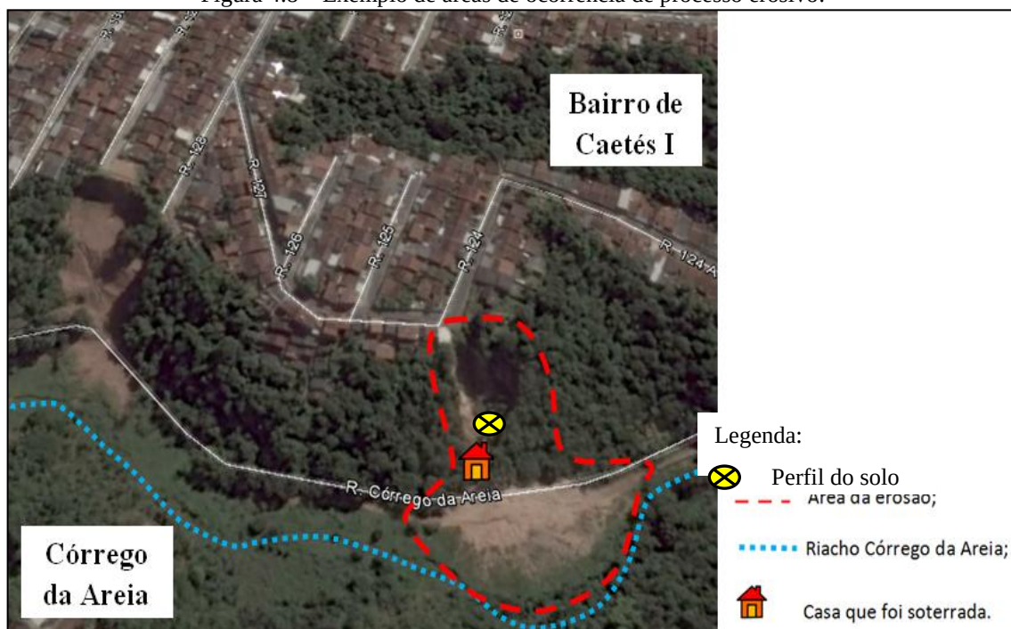
Figura 4.8 – Exemplo de áreas de ocorrência de processo erosivo.
