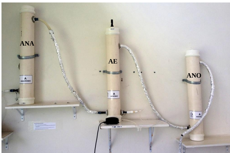
Figura 04 - Conjunto dos três reatores em série e em escala de bancada
