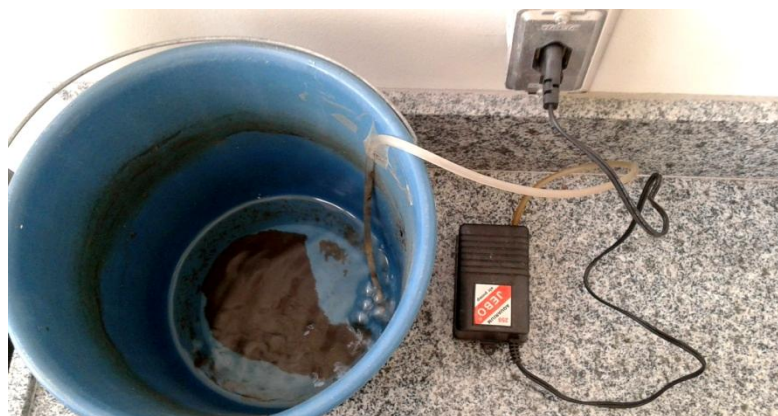
Figura 06 – Enriquecimento da biomassa nitrificante
