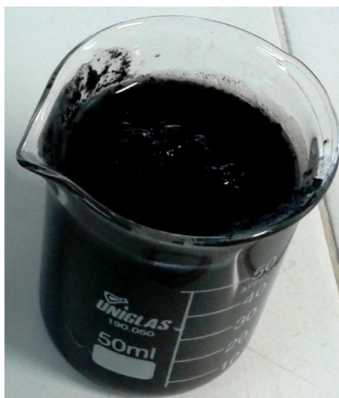
Figura 07 – Lodo do reator UASB/ETE Mangueira para inoculação no reator anaeróbio
