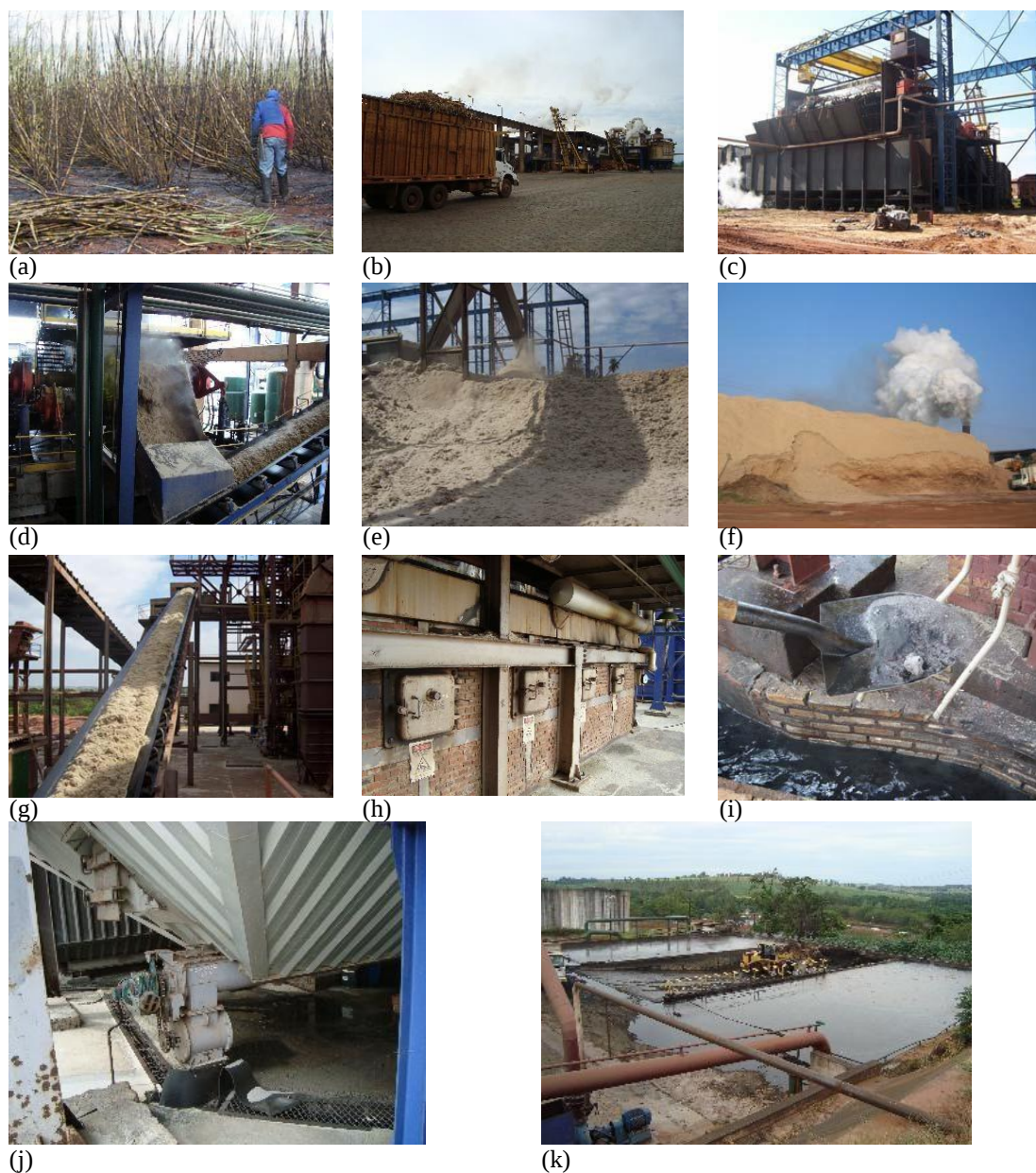
Figura 2.7 - Processo de geração das CBCA.
