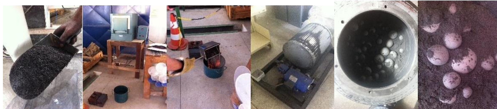
Figura 3.4 – Sequência geral do preparo da CBCA.
