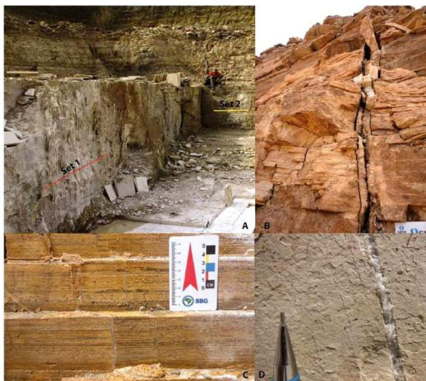
Figura 5.11 - Exemplos da ocorrência das fraturas extensionais nos calcários laminados da Formação Crato. A) Juntas com padrão ortogonal, *set 1* (NW-SE) e *set 2* (NE-SW). Estes planos acabam sendo aproveitados para orientar as frentes de lavra da mina; B) Junta parcialmente preenchida por dissolução de calcita e gipsita; e C e D) *Clusters* de veios preenchidos por calcita recristalizada.
