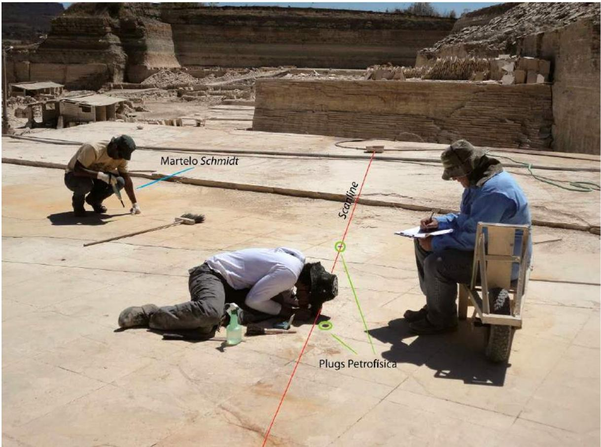
Figura 2.15 – Execução de *scanline* em pavimento de uma frente de lavra de calcário laminado, Mineração Pedras Cariri, Nova Olinda, CE. Neste mesmo afloramento, PT-09, também foram realizadas: caracterização geomecânica com uso do martelo de *Schmidt* e coleta de plugs (verticais ao acamamento) para análise petrofísica.
