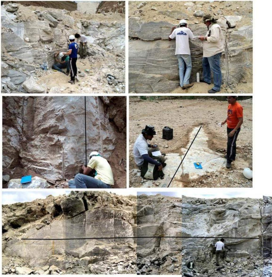
Figura 2.14 – Fotos de trabalho de campo mostrando o procedimento de coleta das atitudes das estruturas em depósitos de evaporitos da Formação Ipubi, nas exposições das minas estudadas. As *scanlines* foram executadas em pavimentos e nas seções das bancadas (vertical e horizontal).
