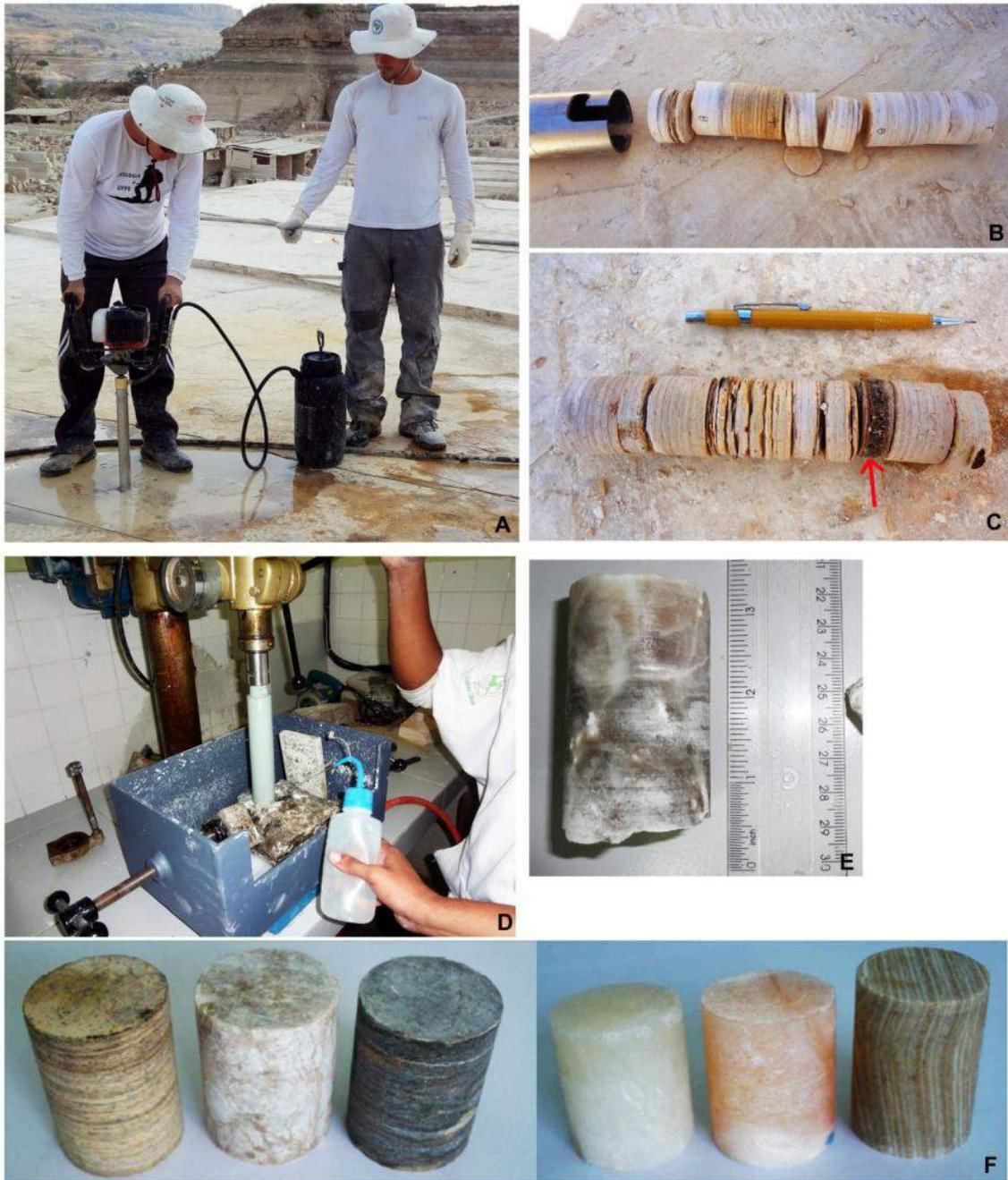
Figura 2.22 – Preparação de plugs para a realização de análises petrofísicas. A) Extração de plugs em afloramentos das unidades estudadas; B e C) Recuperação de plugs da formação Crato (a seta vermelha em C indica uma fratura horizontal, parcialmente preenchida por calcita recristalizada); D e E) extração de plugs de amostras de gipsita no Laboratório de laminação da UFPE; F) Plugs preparados no laboratório de Petrofísica da UFCG.
