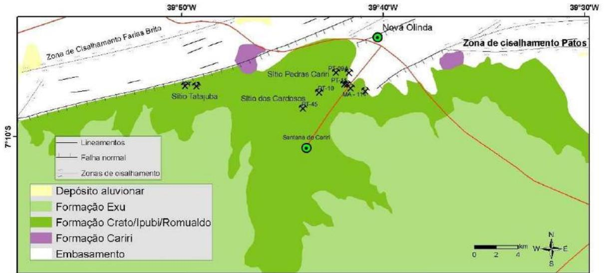
Figura 5.1 - Mapa geológico simplificado da área de estudo na borda Norte da Bacia do Araripe, com a localização das minerações de calcário laminado (Formação Crato) utilizadas para a aquisição dos dados geológicos e geomecânicos.
