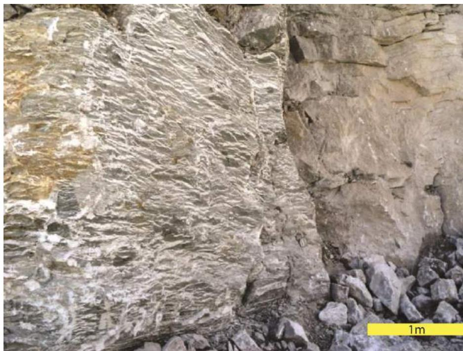
Figura 5.29 – Superfície de um plano de fratura exposta mostrando o preenchimento com argilominerais e finos veios de gipsita fibrosa compondo uma trama planar.
