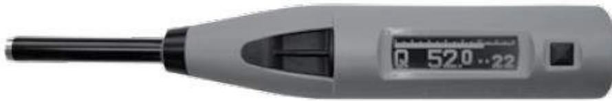
Figura 2.23 - Martelo de *Schmidt* de baixa energia de impacto (*Silver Schmidt* Tipo L) fabricado pela Proceq, utilizado na coleta de dados de resistência mecânica em campo. A escala de medição é denominada coeficiente de rebote [Q], e varia de 0 a 70 (adimensional), e é diretamente proporcional à resistência à compressão uniaxial (UCS) para rochas com valores de UCS que variam entre 10-100 MPa (Fonte: Proceq)
