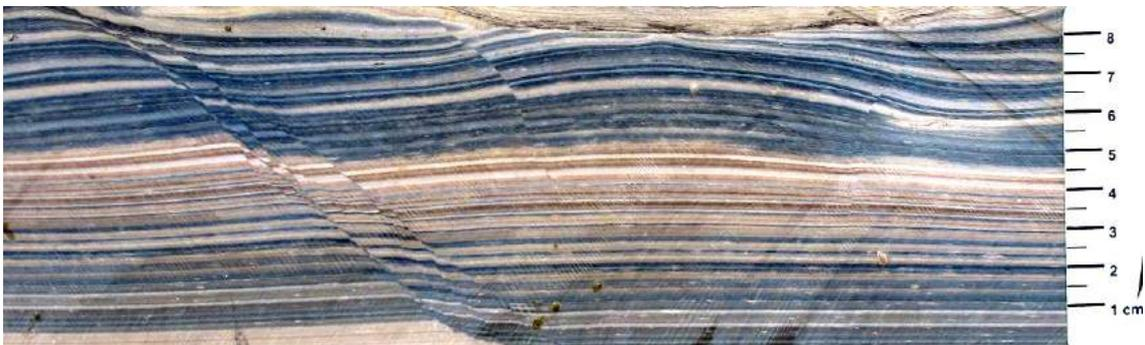
Figura 5.8 - Fratura cisalhante em seção com ângulo de mergulho moderado e (deslocamento) rejeito milimétrico. Notar dobras de arraste e deslizamento dos limites dos grãos, sem fraturamento ou quebraamento extensivo das camadas.
