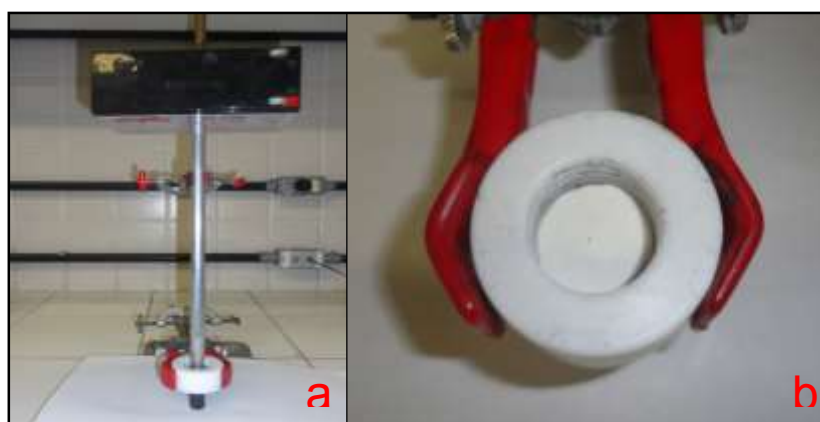
FIGURA 11 – Prensagem da mistura de materiais carbonáceos em pó e isolamento do cátodo com a membrana (papel de filtro), após a adição da solução contendo o substrato.
