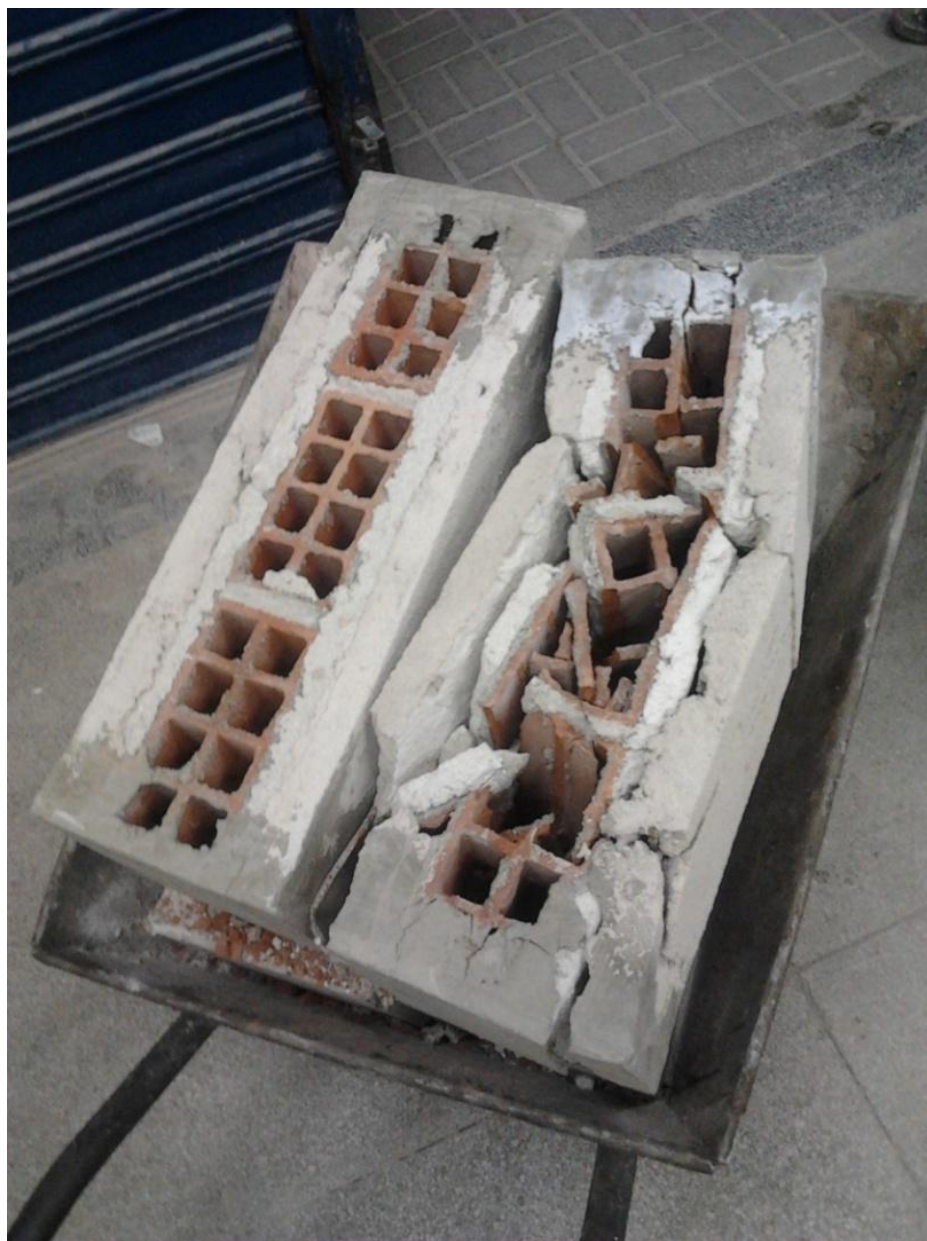
Figura 6.14 – Corpos de prova da mesma amostra indo para o descarte. O da esquerda praticamente sem danos após o ensaio. O da direita que estava sem dano, foi dado deslocamento adicional, após o ensaio simples, com aproximadamente 10 cm
