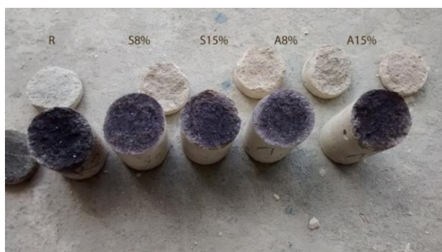
Figura 5.9 – Corpos de prova no ensaio posterior a câmara de cloretos com nitrato de prata
