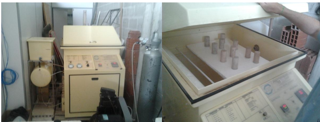
Figura 5.12 – Câmara de névoa salina
