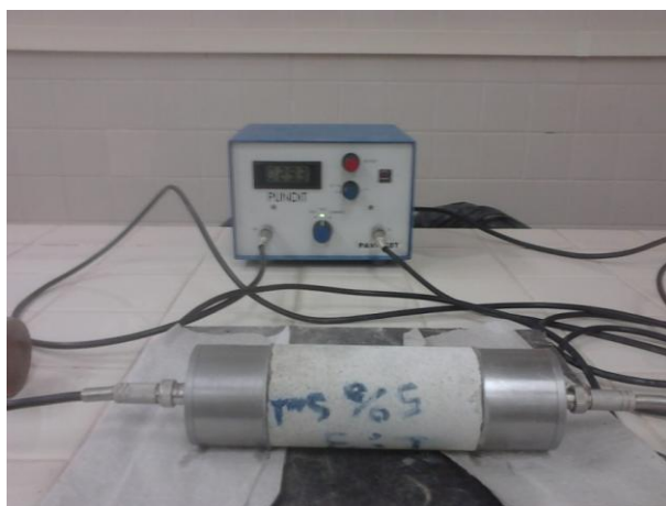
Figura 6.24 – Ensaio de ultrassom em corpo de prova de argamassa
