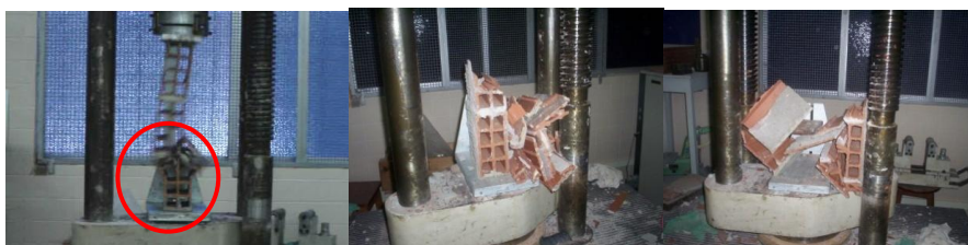
Figura 3.3 - Forma de ruptura dos prismas sem revestimento e com chapisco
