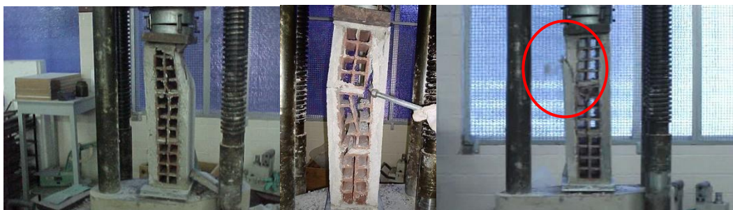
Figura 3.5 - Formas de rupturas dos prismas com revestimento de 3,0 cm
