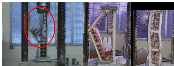
Figura 3.4 - Formas de ruptura dos prismas com revestimento de 2,0 cm
