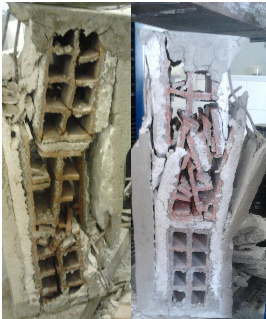
Figura 6.15 – Prismas reforçados sobre substrato revestido (ambos sem avarias visuais até o final do ensaio), com deformação adicional em torno de 12 cm após a conclusão do ensaio (prensa travada)
