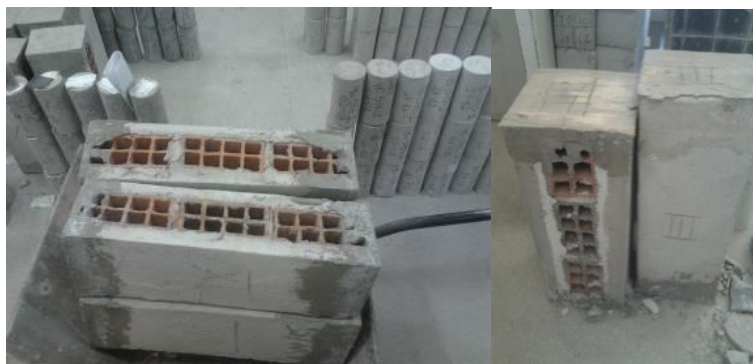
Figura 6.10 – Prismas refroçado e rompidos indo para o descarte. Condição aparentemente sem avarias. Ruptura não explosiva indicando ductilidade
