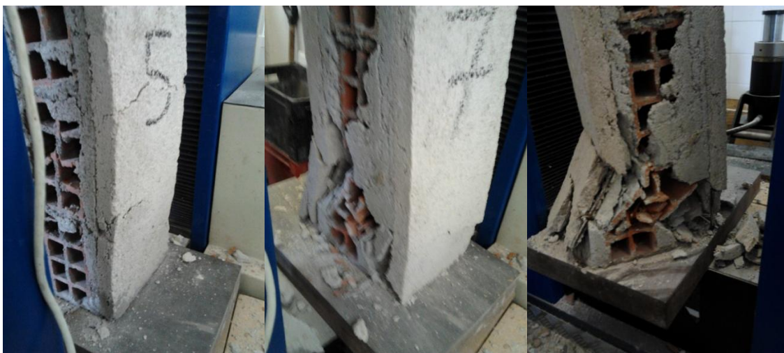
Figura 3.11 - (a): Fissura inicial na região da interface revestimento fraco/revestimento armado do reforço. Alguns septos foram rompidos por tração; (b): prisma 7 com deformação adicional realizada após o término do ensaio de 6 cm aproximadamente. Observam-se blocos totalmente colapsados; (c): mesmo prisma (b) com deformação adicional de 12 cm.
