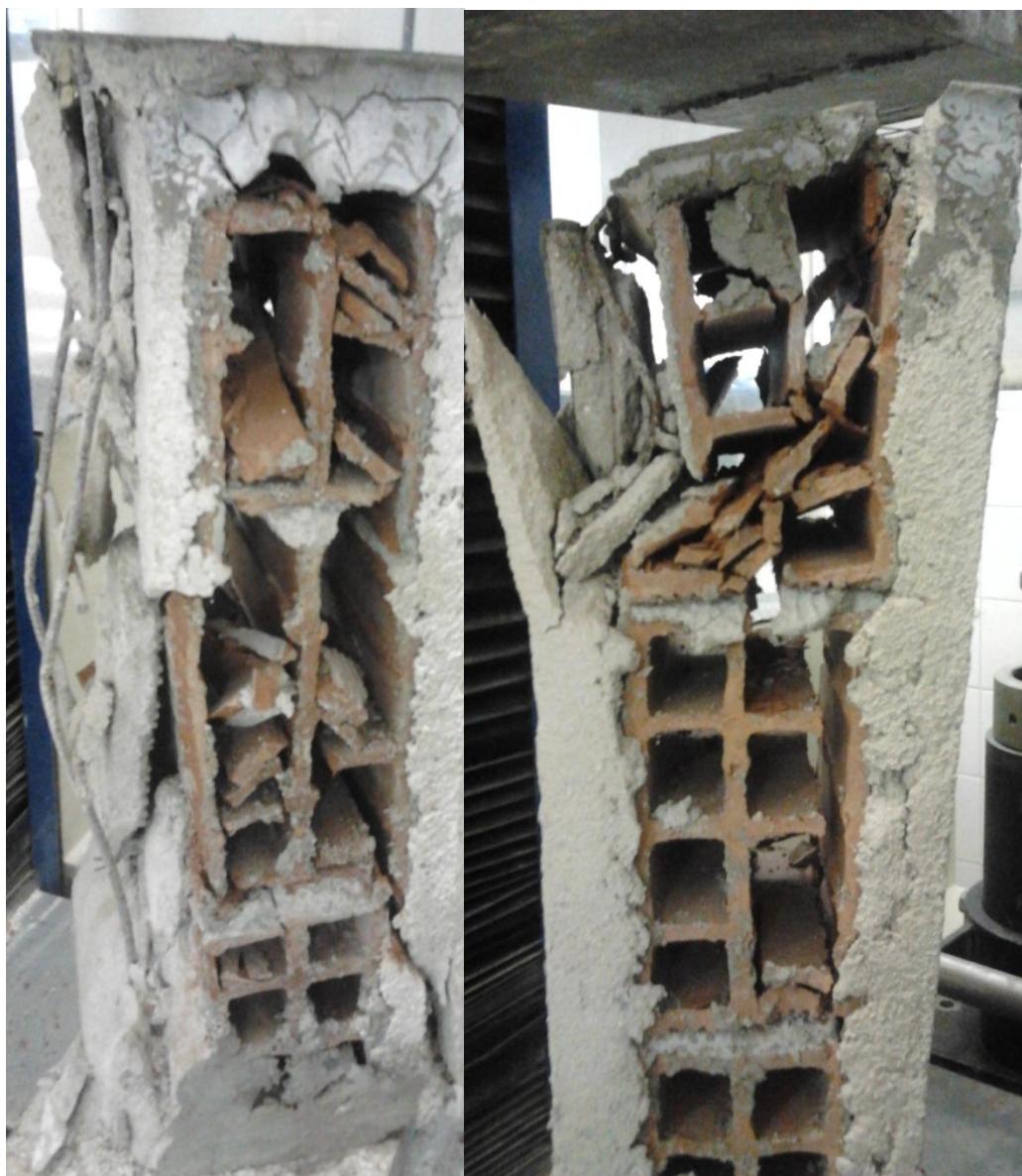
Figura 6.16 – Prismas reforçados sobre substrato sem revestimento, com deslocamento adicional manual em torno de 10 cm após o fim do ensaio
