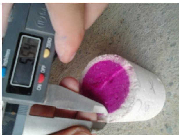
Figura 6.27 – Leitura do corpo de prova do traço forte com 8% de substituição de parte do cimento [condição (b)]
