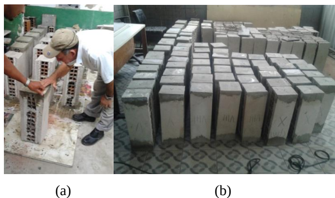
Figura 5.3 - (a): Capeamento dos prismas sobre chapa de compensado revestida com laminado melamínico, óleo de mamona e jornal; (b): armazenamento de alguns prismas capeados
