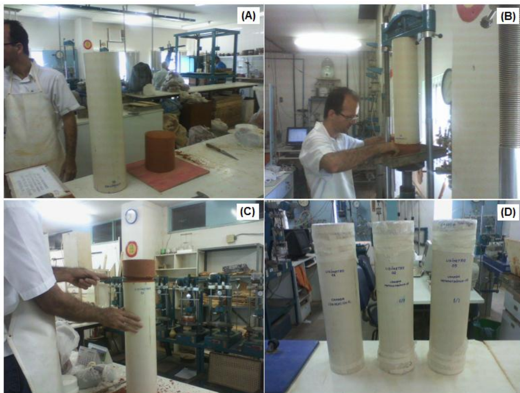
Figura 27 – Confecção dos lisímetros
