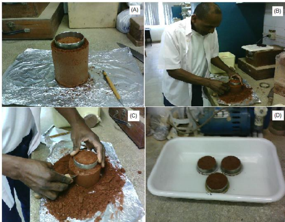
Figura 30 - Confeção dos corpos de prova
