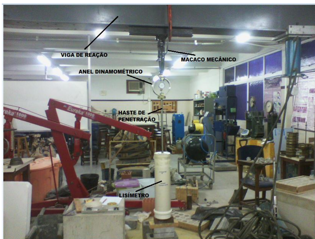
Figura 31 – Ensaio com penetrômetro estático em laboratório
