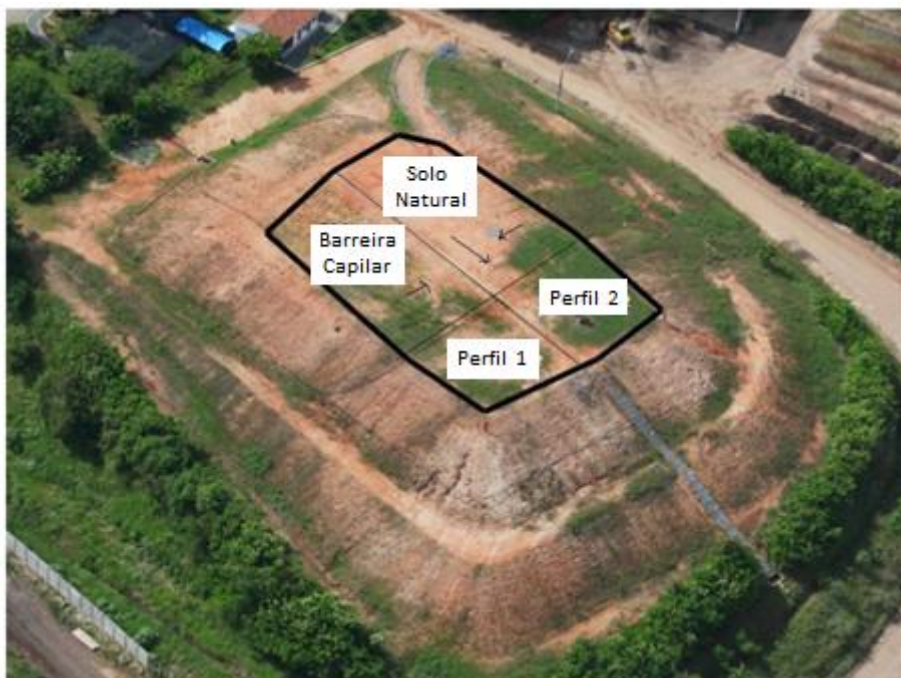
Figura 25 - Divisões das camadas de cobertura experimentais
