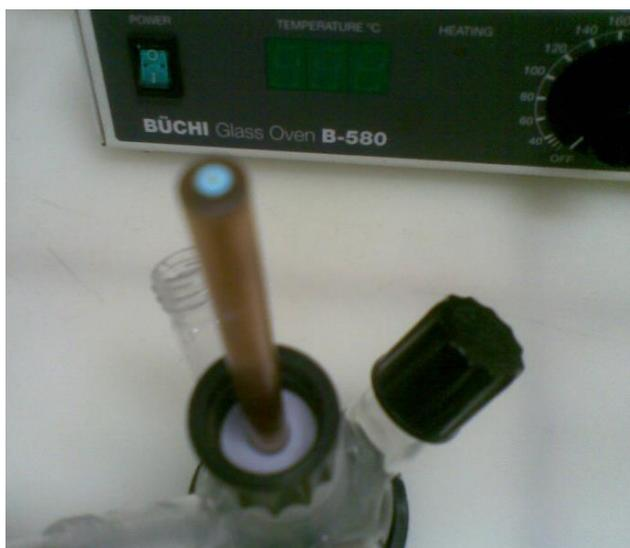
**Figura 1b:** A amostra da [Cu<sub>3</sub>(BTC)<sub>2</sub>.(H<sub>2</sub>O)<sub>3</sub>] sintetizado por via eletroquímica com técnica de voltametria cíclica.
