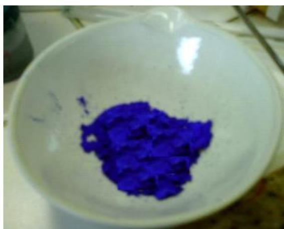
**Figura 3:** A amostra de  $[\text{Cu}_3(\text{BTC})_2]_n$ , por via eletroquímica apresentando cor azul, com o pH da solução final próximo a cinco.
