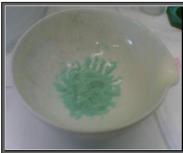
**Figura 16b:** A amostra de  $[Cu_3(BTC)_2.(DMF)_x]_n$ , por via eletroquímica apresentando cor verde, com o pH aparente da solução final próximo a nove.
