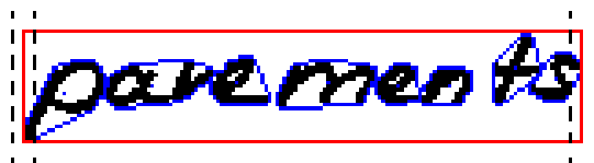
Figura 5.3 A linha tracejada representa a margem de erro adotada para o procedimento de avaliação automática e o retângulo representa o Bounding Box da palavra informado no XML
