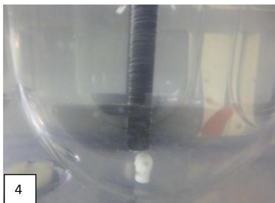
Legenda: 1 - Comprimido no primeiro minuto do teste de dissolução; 2 – Comprimido LBIII após 3h do teste de dissolução; 3 - Comprimido LBIII após 9h do teste de dissolução; 4 - Comprimido LBIII após 25h do teste de dissolução.
